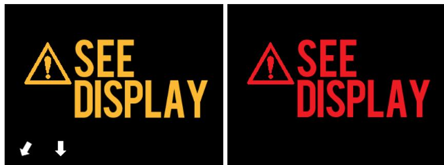
그림 4-24 Makoto™ 컨트롤러의 에러 메시지(왼쪽)와 내부 오류(오른쪽) 메시지. 두 경우 모두 사용자가 시스템 모니터에서 오류 또는 결함 및 다음 조치에 대한 지침을 참조해야 합니다.
