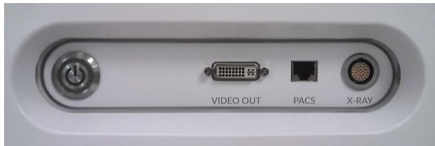
그림 14-1: Makoto Intravascular Imaging System™ 비디오 및 컨트롤 추출 패널
