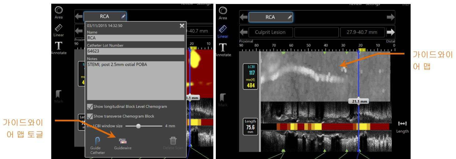
그림 10-4: 가이드와이어 맵 툴이 활성화된(좌측) 스캔 편집창, 혈도그램이 숨겨지고 가이드와이어 맵이 보이는 상태(우측).
