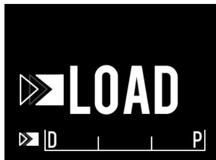
그림 4-21 로드 상태를 가리키는 Makoto™ 컨트롤러 LCD 화면.
