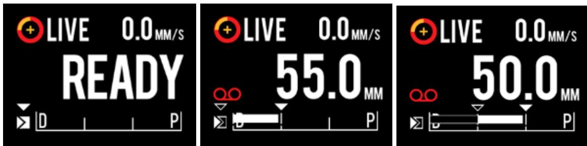
그림 9-5. Makoto™ 컨트롤러 LCD 화면: 준비 위치에서 기록되지 않은 실시간 IVUS 시작(좌측)부터 다음 해석 상단부 및 정지 상태 실시간 IVUS 기록(중앙), 기록 중 상단부 영점화 및 해석(우측). 기록된 실시간 IVUS 중 녹화 아이콘 등장에 주목하십시오. 기록된 실시간 IVUS 중 해석이 수행될 때, 최근 표시(중앙 및 우측)이후 이번 획득의 기록이 이미 수행된 곳에는 내부가 채워진 막대가 나타나며, 가장 최근 표시 이전의 기록은 내부가 빈 막대입니다(우측).
