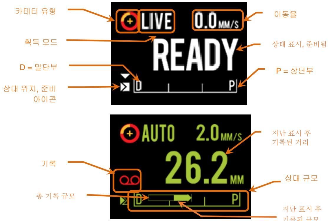
그림 4-17: 준비 위치(상단)의 실시간 IVUS 획득 및 자동 풀백 획득(하단) 도중 Makoto™ 컨트롤러 LCD 표시기
