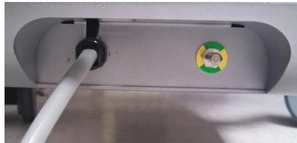
그림 6-2: 우측 하단 모서리에 Makoto Intravascular Imaging System™의 뒷면에 위치한 등전위의 접지 스터드.
