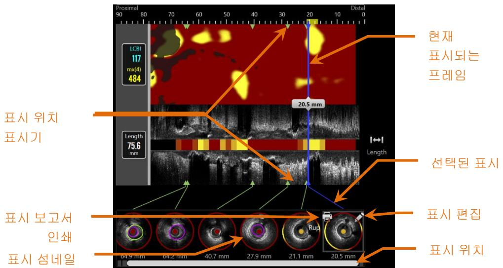
그림 10-8: 표시 위치가 해당 프레임의 내용을 보여주는 식별 가능한 션네일과 함께 헤모그램 및 세로 IVUS 위에 녹색 삼각형 표시기에 의해 표시됩니다.
