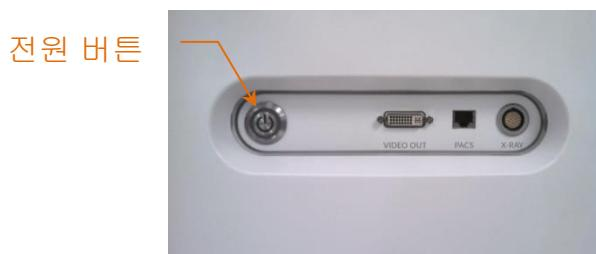
그림 6-1: 전원 버튼이 강조 표시된 Makoto Intravascular Imaging System™ 측면 패널
