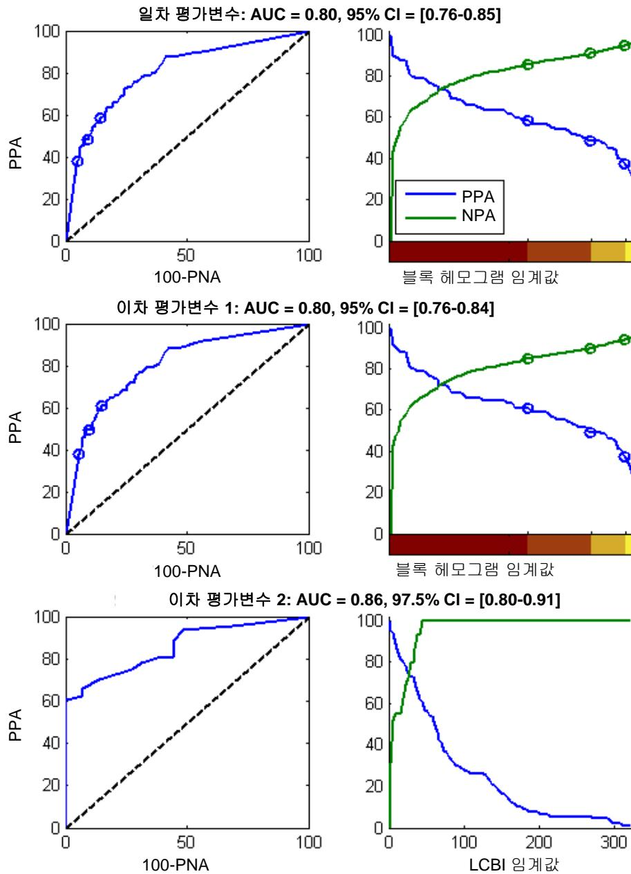
그림 17-1. 3차 시험 평가변수를 위한 ROC 곡선(좌측 열)과 백분율 양성 및 음성 일치 곡선 대 시험 임계값(우측 열). A: 일차 평가변수 - 피막 두께 임계값 없음. 해모그램의 정확성 대 2 mm 블록의 조직학(심장 51개, 세그먼트 122개 및 2 mm 블록 1909개). 블록 해모그램의 3개 색상 헤모그램(경계 식별 적색, 어두운 오렌지색, 밝은 오렌지색 및 노란색)에 원형 표시된 양성 및 음성 일치 백분율이 발생합니다. B: 이차 평가변수 1 - 450마크론의 피막 두께 임계값. C: 이차 평가변수 2 - 지질 핵 부하 지수(LCBI)의 정확성 대 조직학(심장 51개, 세그먼트 120개). PPA: 백분율 양성 일치. PNA: 백분율 음성 일치.
