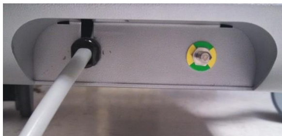
Figur 6-2: Ækvipotentiale jordsøm nederst til højre på bagsiden af Makoto Intravascular Imaging System™.
