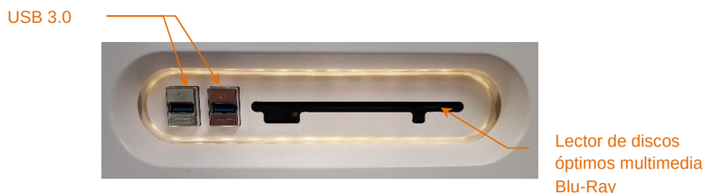
Figura 4-3: Panel de interfaz izquierdo del Makoto Intravascular Imaging System™ (TVC-MC10) que contiene conectores USB 3.0 y un lector de discos óptimos multimedia Blu-Ray.
