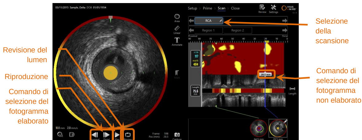
Figura 10-6. Fase di scansione della modalità di acquisizione con i comandi di riproduzione e selezione della scansione evidenziati.
