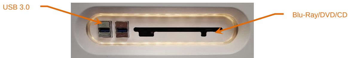
Figura 12-8. Pannello dei supporti rimovibili del sistema Makoto Intravascular Imaging System™
