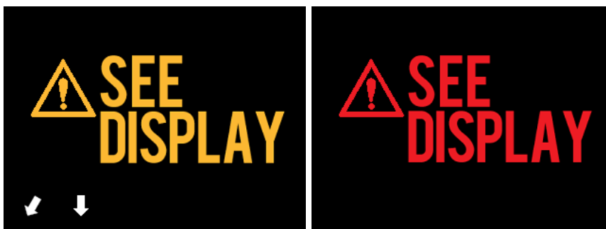
Figura 4-24 Messaggio d'errore (a sinistra) e messaggio di guasto interno (a destra) del Controllore Makoto (tm). In entrambi i casi l'utente dovrebbe consultare il monitor del sistema per istruzioni sul guasto o errore e per le azioni successive.
