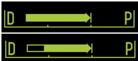
Figura 4-20. Recorded Range (intervallo registrato) dell'acquisizione in corso: Live IVUS, in cui la posizione attuale coincide con la posizione iniziale (in alto), Registrazione Live IVUS, in cui la posizione attuale è prossimale all'ultimo Mark (contrassegno) creato (al centro in alto), Retrazione automatica senza contrassegni (al centro in basso), Retrazione Automatica, in cui la barra colorata indica l'intervallo registrato a partire dall'ultimo Mark (contrassegno) creato (in basso).
