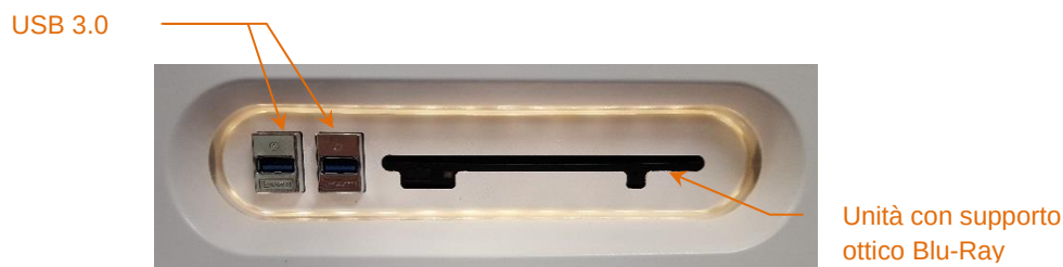
Figura 4-3. Pannello sinistro dell'interfaccia del sistema Makoto Intravascular Imaging System™ (TVC-MC10) contenente connettori USB 3.0 e unità di supporto ottico Blu-Ray.
