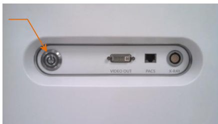
Figura 6-1. Pannello laterale del sistema Makoto Intravascular Imaging System™ con pulsante di accensione evidenziato.
