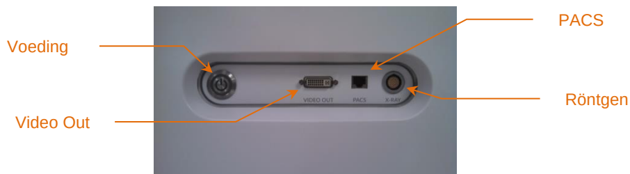
Afbeelding 4-4: Rechter interfacepaneel van het Makoto Intravascular Imaging System™ (TVC-MC10) met de aan/uit-knop, video-uitgang, PACS- en röntgenaansluitingen.
