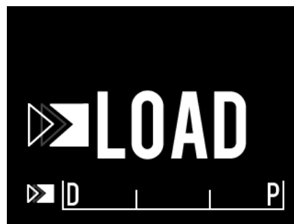
Afbeelding 4-21: Het LCD-scherm van de Makoto™-regelaar dat de LOAD-status aangeeft.
