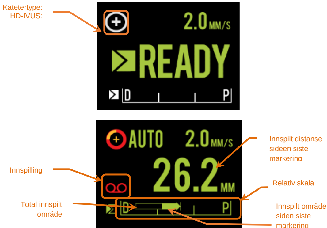
Figur 4-17: Makoto™ Controller LCD-skjermindikatorer i Live IVUS-innsamling i READY (klar) -posisjon med et Dualpro™ IVUS+NIRS-kateter (øverst), inaktiv med et Infraredx Clarispro™ HD-IVUS-kateter koblet til READY (klar) -posisjon (midt), og under automatisk tilbaketrekking med en Dualpro™ IVUS+NIRS kateter (nederst).
