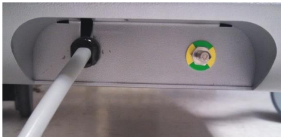
Figur 6-2: Ekvipotentiell jordningsbult längst ner till höger på Makoto™ intravaskulära avbildningssystemets baksida.
