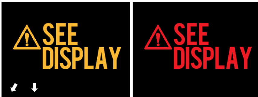
Иллюстрация 4-24 Сообщение об ошибке контроллера Makoto™ (слева) и сообщения о внутренней неисправности (справа). В обоих случаях пользователь должен проверять сообщения на мониторе системы для получения инструкций в отношении ошибки или неисправности, а также дальнейших действий.
