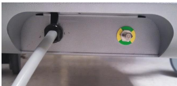
Иллюстрация 6-2; Шпилька эквипотенциального заземления, расположенная на правом нижнем крае на задней стороне Makoto Intravascular Imaging System™.
