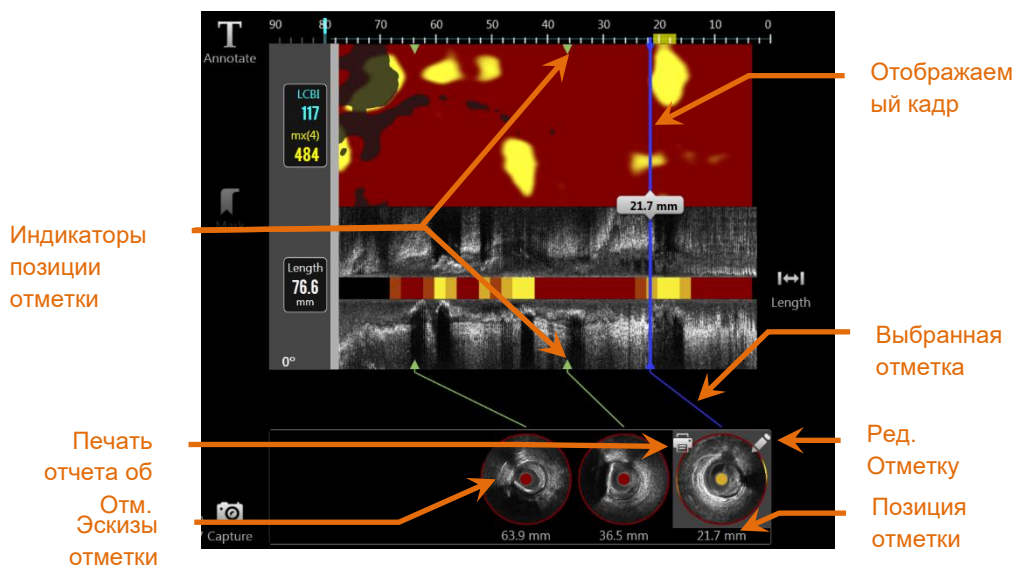
Иллюстрация 10-8: Позиции Отметок отображается индикаторами в форме зеленых треугольников на ChemoGram и Продольном IVUS, а также эскизом, показывающим содержимое кадра.
