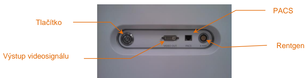
Obrázek 4-4: Pravá strana panelu s rozhraním zobrazovacího systému Makoto Intravascular Imaging System™ (TVC-MC10) obsahující tlačítko napájení, výstup videosignálu a konektory pro integraci systému PACS a rentgenového zařízení.
