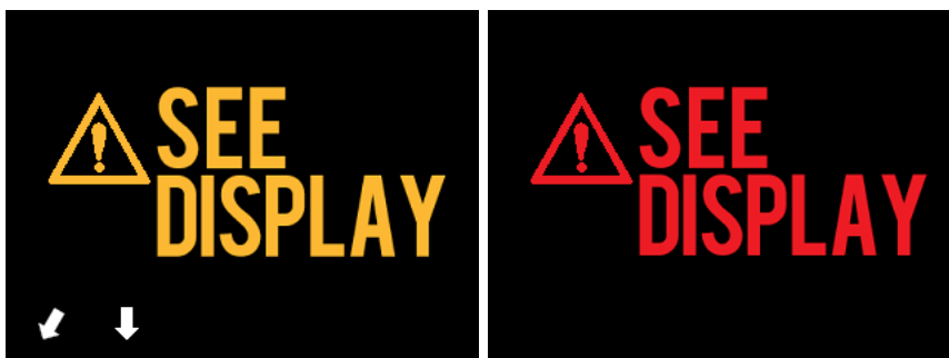
Obrázek 4-24 Chybová zpráva ovladače Makoto(tm) (vlevo) a chybová zpráva interní chyby (vpravo). V obou případech by uživatel měl postupovat podle pokynů uvedených na monitoru systému, jak konkrétní chybu napravit.
