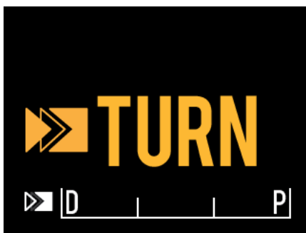
Obrázek 4-22 LCD obrazovka ovladače Makoto™ zobrazující pokyn k otočení rukojeti katétru.
