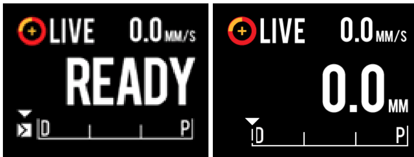
Obrázek 9-2: Ovladač Makoto™ zobrazující živou akvizici IVUS, která není zaznamenávána, v poloze READY (Připraveno) (vlevo) a v poloze 0,0 mm (vpravo).
