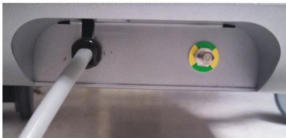
Obrázek 6-2: Uzemňovací kolík pro vyrovnání elektrických potenciálů umístěný na zadní straně zobrazovacího systému Makoto Intravascular Imaging System™ u pravého dolního okraje.
