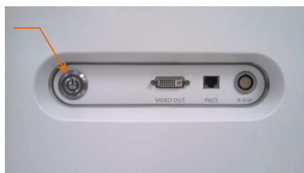
Obrázek 6-1: Boční panel zobrazovacího systému Makoto Intravascular Imaging System™ se zvýrazněným tlačítkem napájení.
