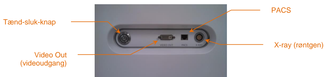
Figur 4-4: Højre grænsefladepanel på Makoto Intravascular Imaging System™ (TVC-MC10), der indeholder Power Button (tænd/sluk-knap) og stikkene Video Out (videoudgang), PACS og X-ray (røntgen).
