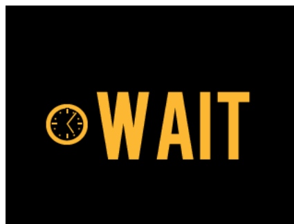
Figur 4-23: Makoto™-styreenhedens LCD-skærm, der angiver at enheden venter på, at systemet færdiggør opstart.
