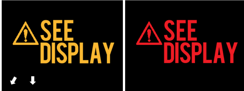
Abbildung 4-24: Die Meldungen Makoto™ Controller-Fehlermeldung (links) und interner Fehler (rechts). In beiden Fällen empfiehlt es sich, den Systemmonitor zu konsultieren, um Anweisungen zu dem Fehler oder der Störung und den nächsten Aktionen zu erhalten.
