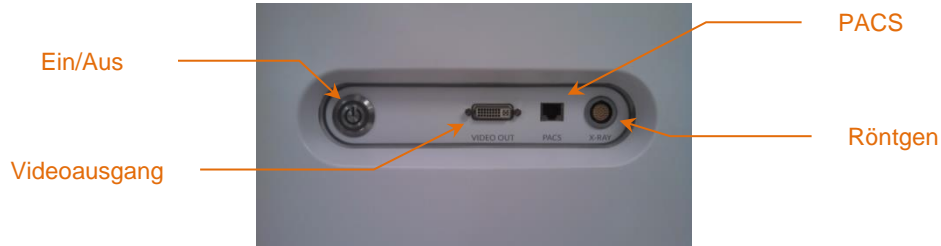
Abbildung 4-4: Rechtsseitiges Schnittstellen-Panel des Makoto Intravascular Imaging System™ (TVC-MC10), mit Ein-/Ausschalter, Videoausgang, PACS und Röntgen-Integrationsanschlüssen.
