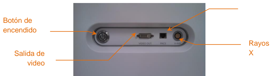
Figura 4-4: Panel de interfaz del lado derecho del Makoto Intravascular Imaging System™ (TVC-MC10) que contiene el botón de encendido, la salida de video, PACS y conectores de integración de rayos X.
