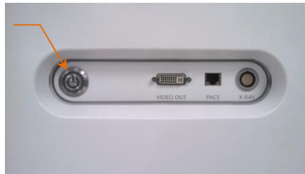
Figura 6-1: Panel lateral del Makoto Intravascular Imaging System™ con el botón de encendido marcado.
