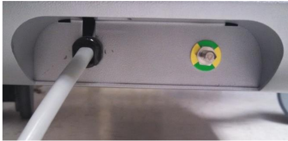
Figura 6-2; Terminal equipotencial de conexión a tierra en la parte posterior del Makoto Intravascular Imaging System™ en el borde inferior derecho.
