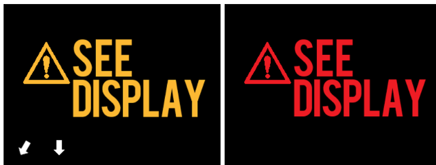
Figura 4-24 El mensaje de error del Controlador Makoto™ (izquierda) y los mensajes de falla interna (derecha). En ambos casos, el usuario debe consultar el monitor del sistema para ver instrucciones sobre las próximas acciones a realizar para corregir el error o la falla.
