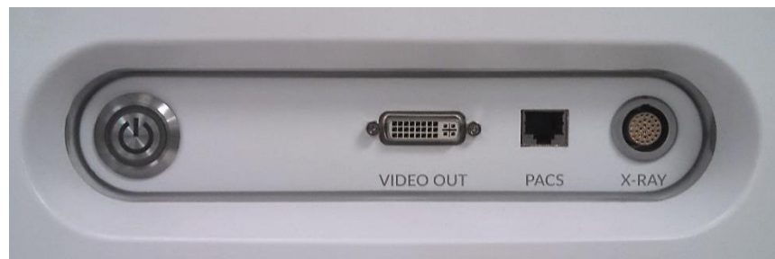
Figura 14-1: Panel de exportación de video y control de Makoto Intravascular Imaging System™
