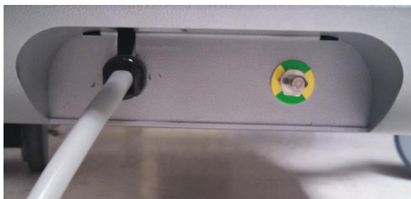
Figura 6-2. Il bullone di terra equipotenziale situato sul retro del sistema Makoto Intravascular Imaging System™ nell'angolo inferiore destro.
