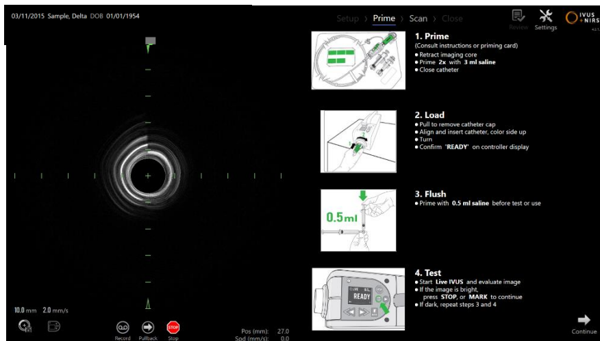
Figura 8-1. Indicazioni su schermo per il priming fornite nella fase di priming della modalità di acquisizione.
