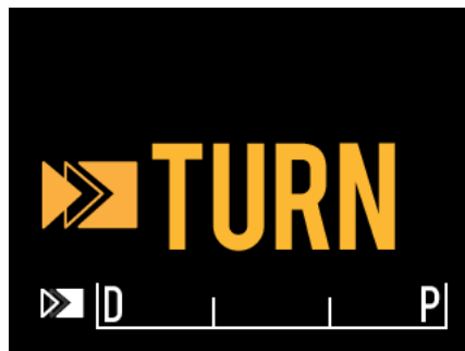
Figura 4-22. Schermo LCD del controller Makoto™ indicante l'istruzione di ruotare la maniglia del catetere.
