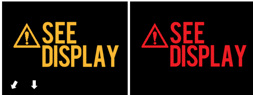
Figura 4-24 Messaggio d'errore (a sinistra) e messaggio di guasto interno (a destra) del Controllore Makoto (tm). In entrambi i casi l'utente dovrebbe consultare il monitor del sistema per istruzioni sul guasto o errore e per le azioni successive.
