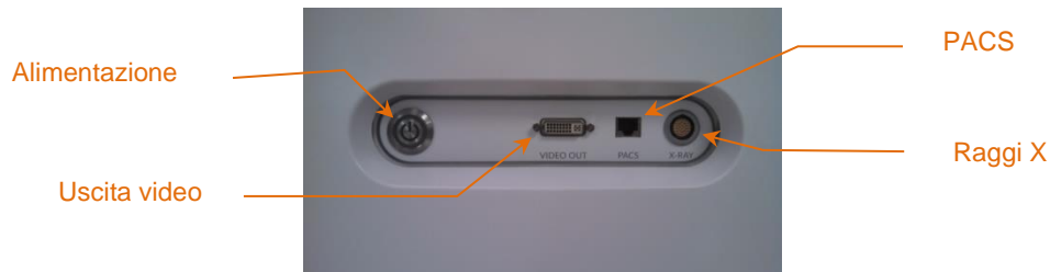
Figura 4-4. Pannello destro dell'interfaccia del sistema Makoto Intravascular Imaging System™ (TVC-MC10) contenente il pulsante di alimentazione, uscita video, PACS e connettori di integrazione raggi X.
