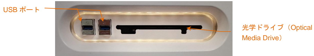
図 4-3 : USB3.0 ポート及び Blu-Ray 光学ドライブを含む Makoto Intravascular Imaging System™ (TVC-MC10) 左側インターフェースパネル
