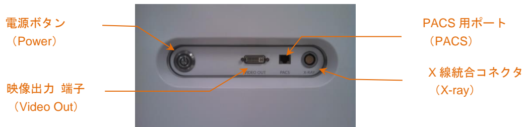
図 4-4 : 電源ボタン、映像出力端子、PACS 用ポート、および X 線統合コネクタを含む Makoto Intravascular Imaging System™ (TVC-MC10) の右側インターフェースパネル
