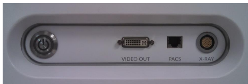
図 14-1 : 映像出力端子 (VIDEO OUT)、PACS 用ポート、および X 線統合コネクタ (X-RAY) を含むインターフェースパネル
