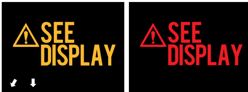
図 4-24 Makoto (tm) コントローラのエラーメッセージ（左）と内部障害（右）メッセージ。どちらの場合も、ユーザはシステムモニターでエラーまたは障害と次のアクションについての指示を調べる必要があります。
