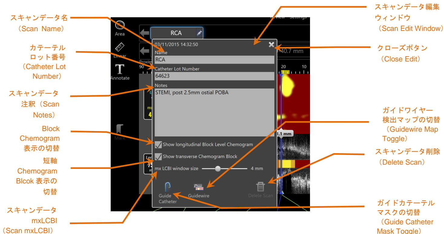
図 10-2 : スキャン (Scan) フェーズ上で選択され、“Pre” に編集されたスキャンデータ編集ウィンドウ
