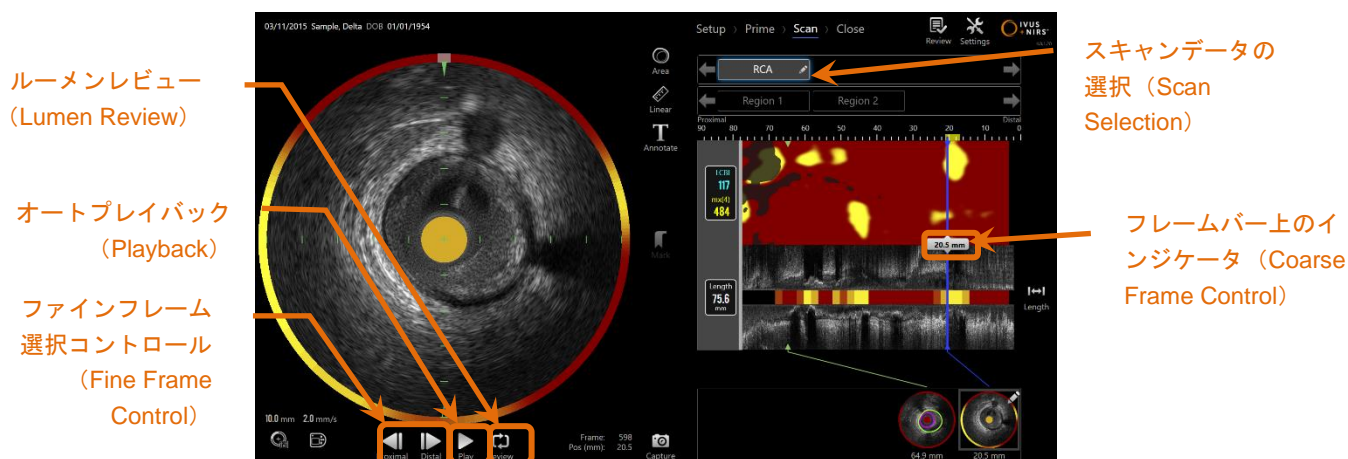
図 10-6 : スキャンデータ選択による取得 (Acquisition) モードのスキャン (Scan) フェーズおよびフレームコントロールがハイライト表示されます
