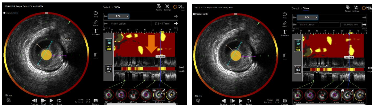
図 10-22 : 脂質プールをケモグラムの端から離してビューと解析処理やすくするため、ケモグラムを回転できます。
