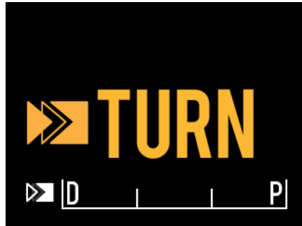
그림 4-22 카테터 손잡이를 회전시키라는 지시를 가리키는 Makoto™ 컨트롤러 LCD 화면.
