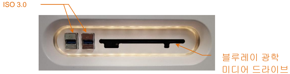
그림 4-3: USB 3.0 커넥터 및 블루레이 광학 미디어 드라이브를 포함하는 Makoto Intravascular Imaging System™ (TVC-MC10)의 좌측 인터페이스 패널.
