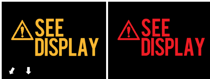
그림 4-24 Makoto™ 컨트롤러의 에러 메시지(왼쪽)와 내부 오류(오른쪽) 메시지. 두 경우 모두 사용자가 시스템 모니터에서 오류 또는 결합 및 다음 조치에 대한 지침을 참조해야 합니다.
