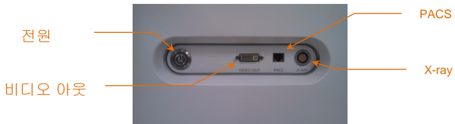
그림 4-4: 전원 버튼, 비디오 아웃, PACS, 및 X-ray 통합 커넥터를 포함한 Makoto Intravascular Imaging System™ (TVC-MC10)의 우측 인터페이스 패널.
