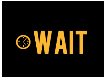
그림 4-23 시스템 가동 완료를 대기하고 있는 상태를 가리키는 Makoto™ 컨트롤러 LCD 화면.
