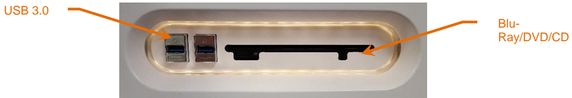
Afbeelding 12-8: Makoto Intravascular Imaging System™ paneel voor verwisselbare media
