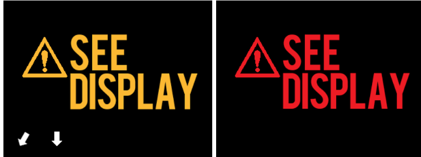
Afbeelding 4-24: Foutmelding van de Makoto(tm)-regelaar (links) en meldingen van interne fouten (rechts). In beide gevallen moet de gebruiker het systeemscherm raadplegen voor instructies over de fout of storing en voor volgende stappen.
