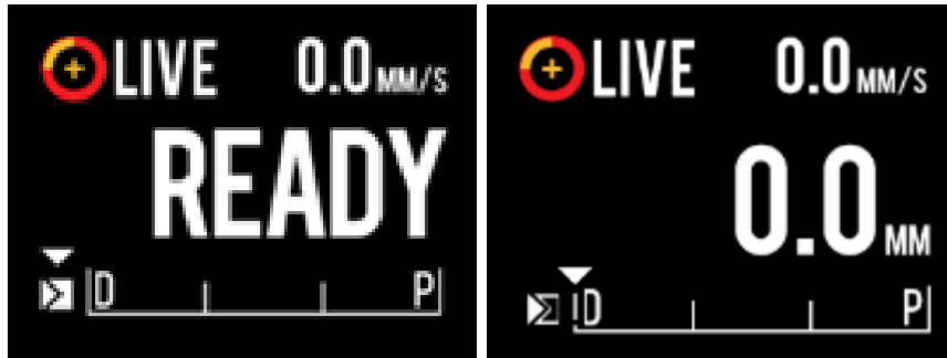
Afbeelding 9-2: Makoto™-regelaar met Live IVUS-gegevens die niet worden opgenomen op de READY-positie (links) en 0,0 mm positie (rechts).
