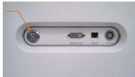
Afbeelding 6-1: Makoto Intravascular Imaging System™, zijpaneel met aan/uit-knop gemarkeerd.
