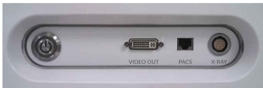
Afbeelding 14-1: Makoto Intravascular Imaging System™-paneel voor video en exporthoutknoppen
