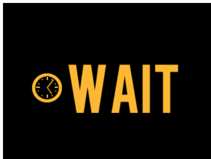
Afbeelding 4-23: Het LCD-scherm van de Makoto™-regelaar geeft een status aan om te wachten tot het systeem volledig is opgestart.
