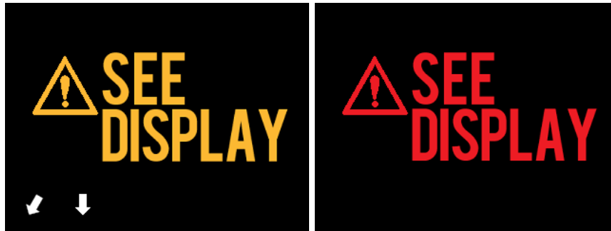
Figur 4-24 Feilmelding for Makoto(tm)-kontroller (venstre) og intern feilmeldinger (høyre) begge tilfeller bør brukeren sjekke systemmonitoren for instruksjoner om feilen og hvilke handlinger som må igangsettes.
