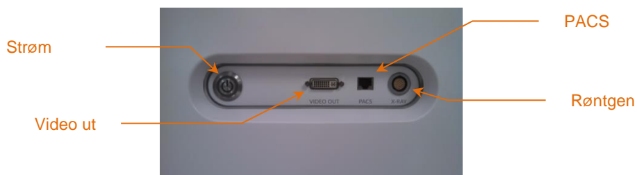
Figur 4-4: Høyre side-grensesnittpanel i Makoto Intravascular Imaging System™ (TVC-MC10) som inneholder strømknappene, videoutgangene, PACS og røntgenintegrasjonskontakter.
