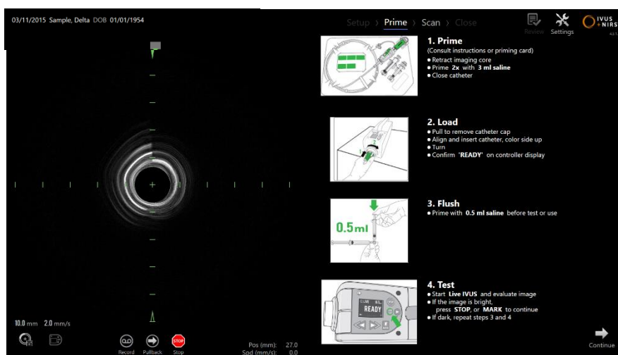
Figur 8-1: Primeveiledning gitt på skjermen i primefasen av avbildningsmodusen.
