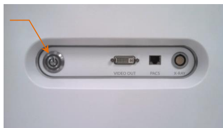
Figur 6-1: Makoto Intravascular Imaging System™-sidepanel med strømknapp fremhevet.
