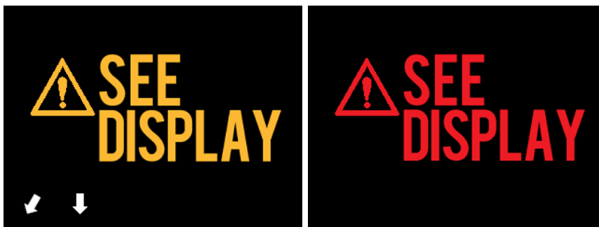
Figura 4-24 A mensagem de erro do Controlador Makoto™ (esquerda) e mensagens de falha interna (direita). Em ambos os casos, o usuário deve consultar o monitor do sistema para obter instruções sobre o erro ou falha e as próximas ações.
