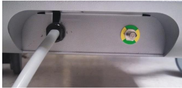
Figura 6-2; Pino de aterramento equipotencial localizado na parte traseira do Makoto Intravascular Imaging System™ na borda inferior direita.
