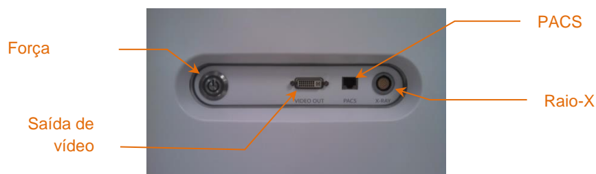
Figura 4-4: Painel de interface do lado direito do Makoto Intravascular Imaging System™ (TVC-MC10) contendo o botão liga/desliga, saída de vídeo, PACS e conectores de integração de raios-X.
