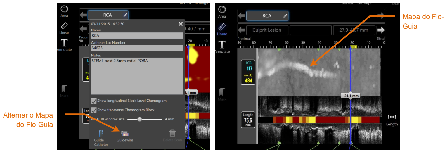
Figura 10-4: Janela de Edição da Varredura com a Ativação da Alternância do Mapa de Fios Guia (esquerda); O Chemogram está oculto e o Mapa do fio-guia está visível (à direita).
