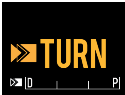
Figura 4-22 A tela LCD do Controlador Makoto™ indicando uma instrução para girar a alça do cateter.
