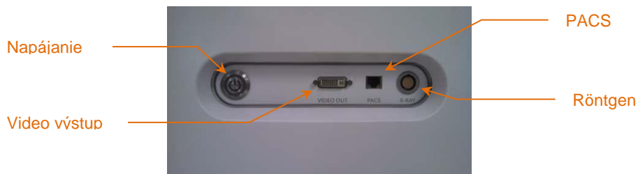
Obrázok 4-4: Panel rozhrania na pravej strane intravaskulárneho zobrazovacieho systému Makoto™ (TVC-MC10) s tlačidlom Napájanie, video výstupom, PACS a konektorom na pripojenie röntgenu.
