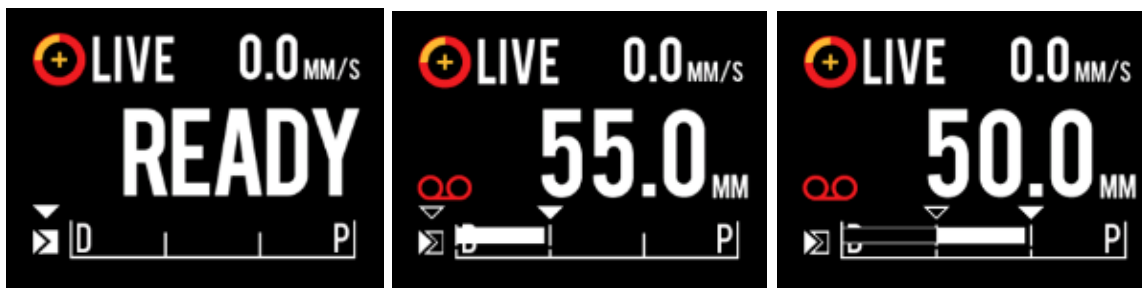
Figur 9-5. Makoto™ kontroller LCD-skärm med en Dualpro™ IVUS+NIRS avbildningskateter ansluten under processen för övergång från början av ej inspelad Live IVUS vid READY (vänster) till inspelning och sedan översätta proximal och stationär Live IVUS (mitten) till nollning och översätter proximal under inspelning (höger). Notera hur inspelningsikonen ser ut under inspelad Live IVUS. När översättning utförs under inspelad Live IVUS visas en hel stapel där inspelningen i detta förvärv redan utfördes sedan det senaste märket (mitten och höger) och inspelningen före det senaste märket är en tom stapel (höger).
