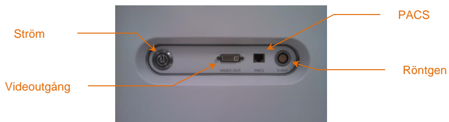
Figur 4-4: Höger gränssnittspanel på Makoto™ intravaskulärt avbildningssystem (TVC-MC10) med strömbrytare, videoutgång, PACS- och röntgenanslutningar.
