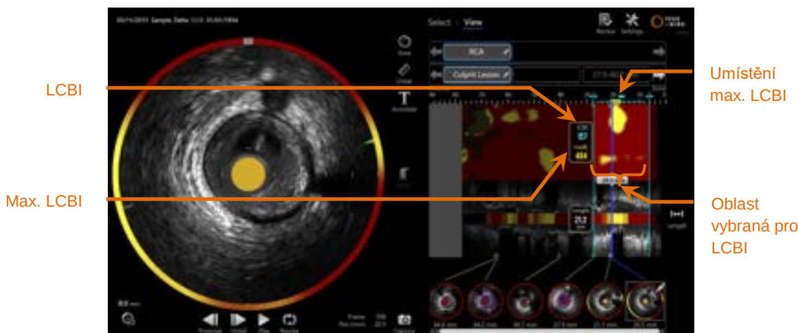
4-26: Místní a maximální hodnota LCBI pro vybranou oblast se zobrazují vlevo od chemogram.
