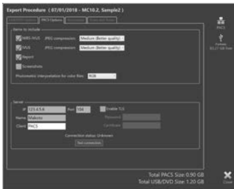
Obrázek 12-11: Okno pro vlastní export umožňující konfigurování alternativního síťového umístění pro ukládání dat.
