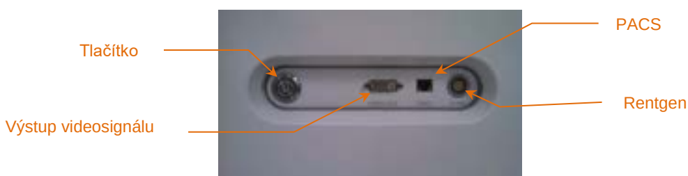
Obrázek 4-4: Pravá strana panelu s rozhraním zobrazovacího intravaskulární zobrazovací systém Makoto® (TVC-MC10) obsahující tlačítko napájení, výstup videosignálu a konektory pro integraci systému PACS a rentgenového zařízení.
