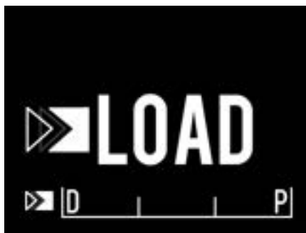
Obrázek 4-21 LCD obrazovka ovladače Makoto® oznamující stav LOAD (Zavést).
