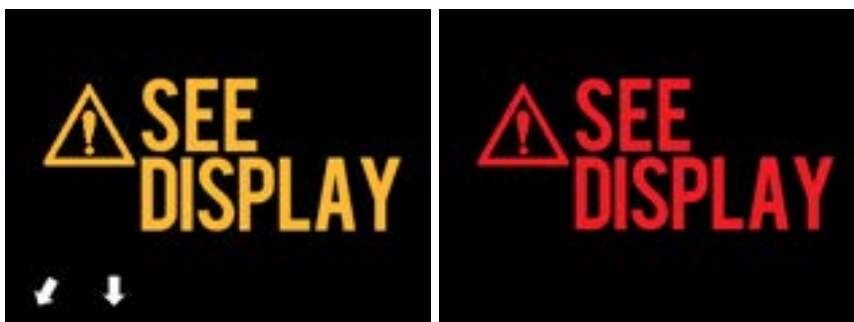
Obrázek 4-24 Chybová zpráva ovladače Makoto® (vlevo) a chybová zpráva interní chyby (vpravo). V obou případech by uživatel měl postupovat podle pokynů uvedených na monitoru systému, jak konkrétní chybu napravit.
