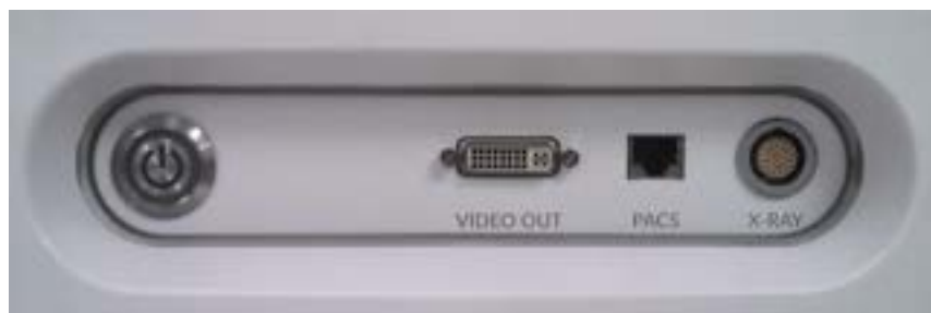
Obrázek 14-1: Panel zobrazovacího intravaskulární zobrazovací systém Makoto® pro ovládání výstupu a exportu videosignálu.
