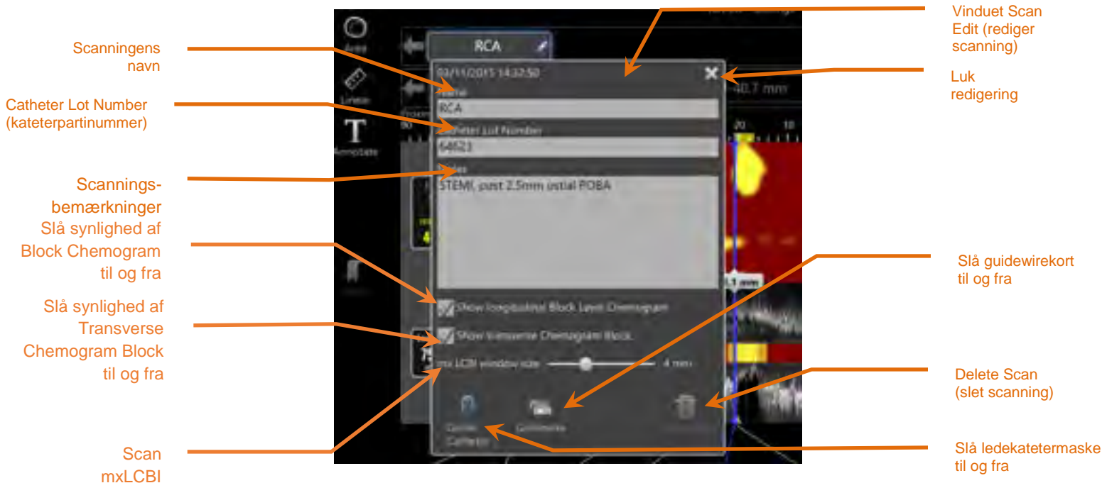
Figur 10-2: Vinduet Scan Edit (rediger scanning) åbent for "RCA".
