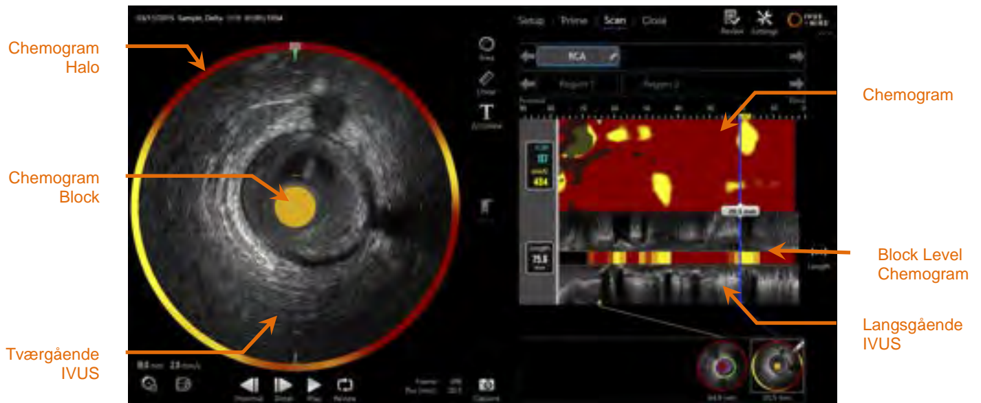
Figur 4-10: Scan-fasen i tilstanden Acquisition (tilvejebringelse) med hovedvisningerne for de angivne billedoplysninger.
