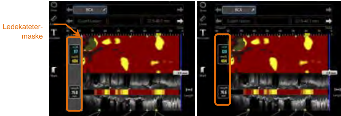
Figur 10-3: Vinduet Scan Edit (rediger scanning) med ledekatetermaske slået til (venstre). Vinduet Scan Edit (rediger scanning) med ledekatetermaske slået fra (højre).
