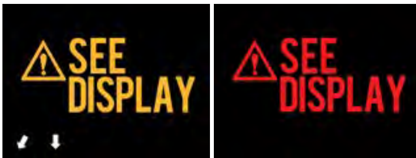
Figur 4-24 Fejlmeddelelser i Makoto®-styreenheden (venstre) og interne fejlmeddelelser (højre). I begge tilfælde skal brugeren følge instruktionerne på systemskærmen for en vejledning i fejlen og de næste handlinger.
