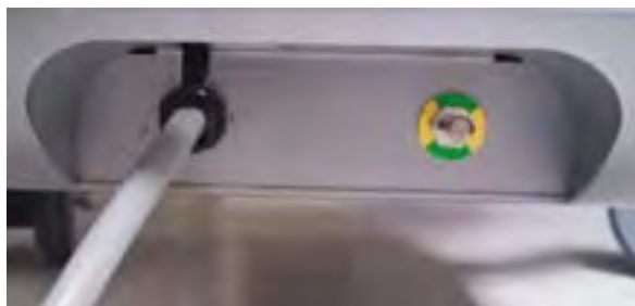
Figur 6-2: Ækvipotentiale jordsøm nederst til højre på bagsiden af Makoto® Intravaskulært billeddannelsessystem.
