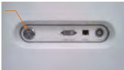
Figur 6-1: Sidepanelet på Makoto® Intravaskulært billeddannelsessystem med fremhævet tænd/sluk-knap.
