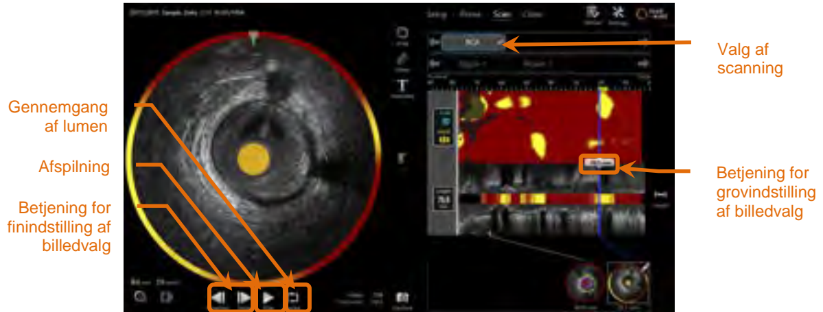
Figur 10-6: Scan-fasen i tilstanden Acquisition (tilvejrbringelse) med fremhævet betjening for valg af scanning og afspilning.
