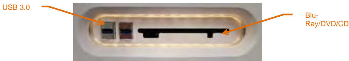
Figur 12-8: Makoto® Intravaskulært billeddannelsessystem-panel til flytbare medier.
