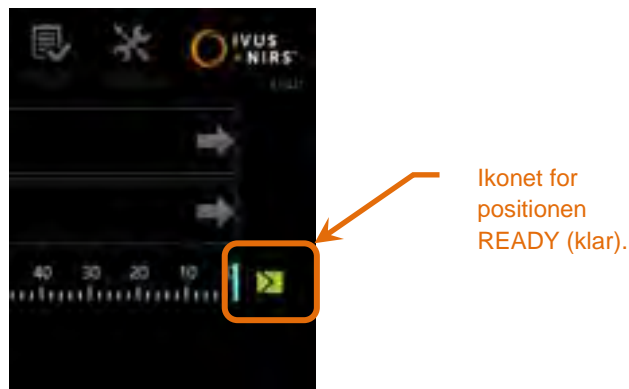
Figur 4-18: Når Makoto®-styreenheden er i positionen READY (klar), vises ikonet READY (klar) på højre side af Makoto®-konsolskærmen.
