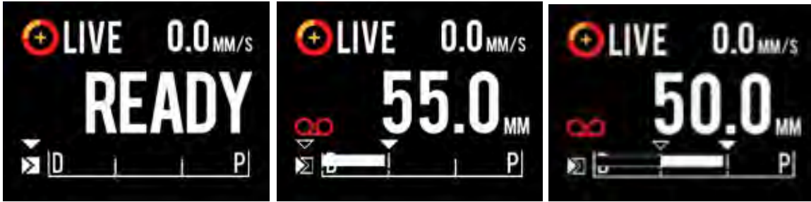
Abbildung 9-5: LCD-Bildschirm des Makoto®-Controllers mit angeschlossenem IVUS+NIRS-Durchleuchtungskatheter während des Übergangs vom Beginn der nicht aufgezeichneten Live-IVUS-Aufzeichnung bei BEREIT (links) zur Aufzeichnung und anschließenden proximalen Übertragung und stationären Live-IVUS-Aufzeichnung (Mitte) zur Nullstellung und proximalen Übertragung während der Aufzeichnung (rechts). Beachten Sie das Erscheinen des Aufnahmesymbols während der Live-IVUS-Aufnahme. Wenn während der Live-IVUS-Aufnahme eine Übertragung durchgeführt wird, erscheint ein durchgehender Balken, wenn die Aufnahme in dieser Akquisition seit der letzten Markierung bereits durchgeführt wurde (Mitte und rechts), und die Aufnahme vor der letzten Markierung ist ein leerer Balken (rechts).
