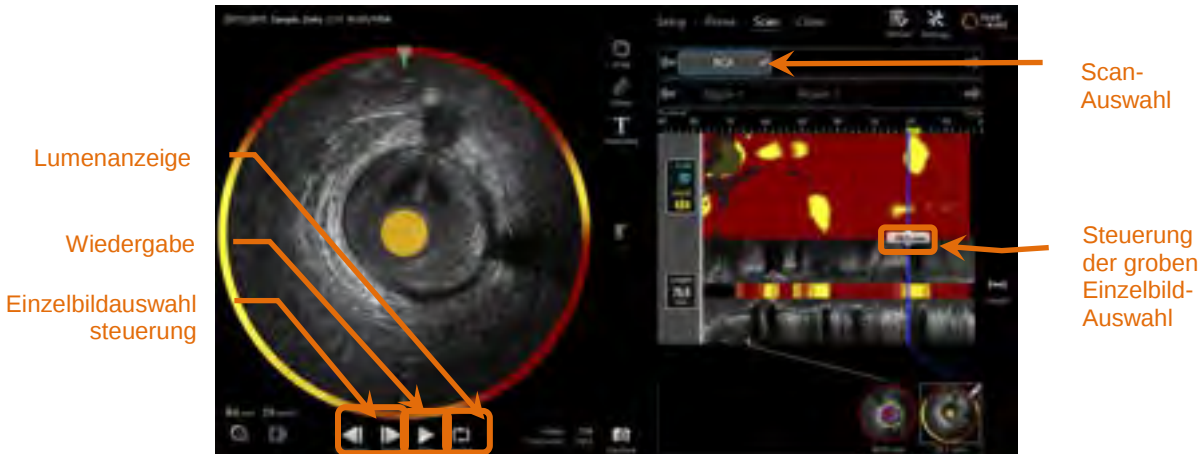
Abbildung 10-6: Scan-Phase des Erfassungsmodus mit hinterleuchteten Steuerelementen zur Scan-Auswahl und Wiedergabe.
