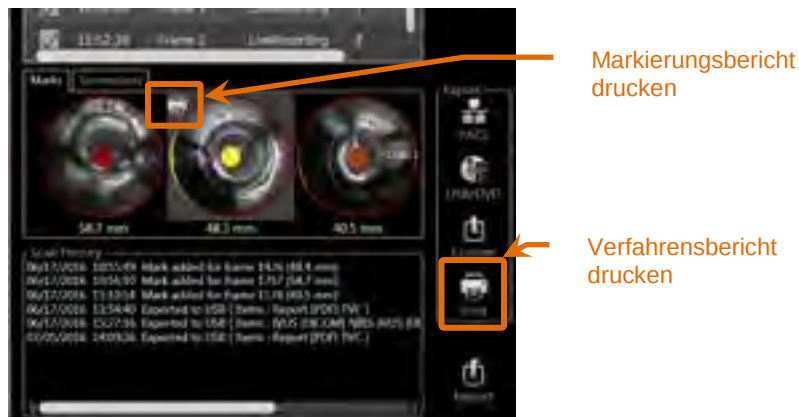
Abbildung 12-5: Auswahl-Phase mit hinterleuchtetem Steuerelement Markierungsbericht drucken.
