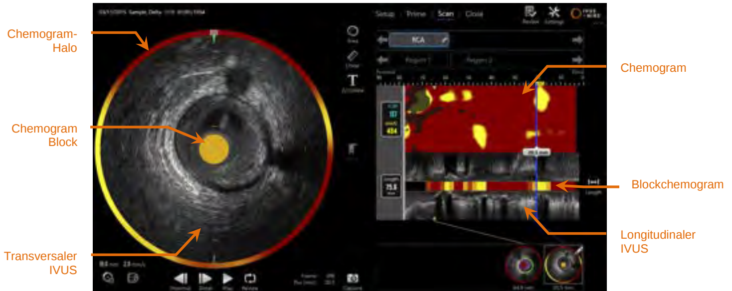
Abbildung 4-10: Scan-Phase des Erfassungsmodus mit dargestellter Anzeige der wichtigsten Bildinformationen.
