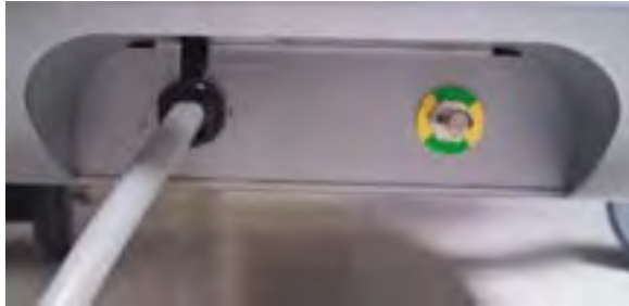
Abbildung 6-2: Der Potentialausgleichsanschluss befindet sich in der unteren rechten Ecke an der Rückseite des Makoto® Intravaskulären Bildgebungssystems.
