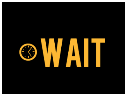
Εικόνα 4-23 Η οθόνη LCD του Makoto® controller με ανάδειξη μιας κατάστασης αναμονής για ολοκλήρωση της εκκίνησης από το σύστημα.
