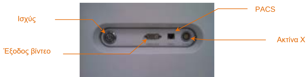
Εικόνα 4-4: Δεξιός πλευρικός πίνακας διεπαφής του συστήματος ενδαγγειακής απεικόνισης Makoto® (TVC-MC10) που περιέχει τους συνδέσμους του διακόπτη ισχύος, της εξόδου βίντεο, του PACS και της ενσωμάτωσης του ακτινογραφικού συστήματος.
