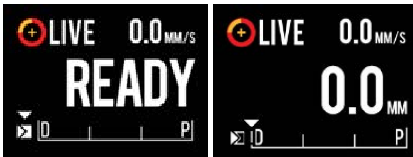
Εικόνα 9-2. Ο Makoto® controller που δείχνει λήψη Live IVUS που δεν είναι εγγεγραμμένη στη θέση READY (Ετοιμότητα) (αριστερά) και στη θέση 0.0 mm (δεξιά).
