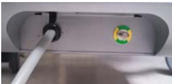
Εικόνα 6-2: Ισοδυναμικός πείρος γείωσης που βρίσκεται στο πίσω μέρος του συστήματος ενδαγγειακής απεικόνισης Makoto® στην κάτω δεξιά άκρη.
