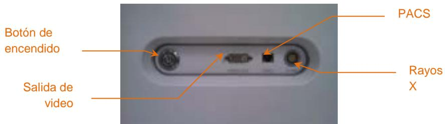
Figura 4-4: Panel de interfaz del lado derecho del Sistema de Imágenes Intravascular Makoto® (TVC-MC10) que contiene el botón de encendido, la salida de video, PACS y conectores de integración de rayos X.
