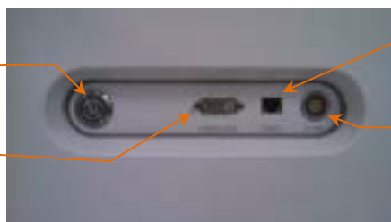
Figure 4-4 : panneau d'interface du côté droit du Makoto® Système d'imagerie intravasculaire (TVC-MC10) intégrant le bouton d'alimentation et les ports de sortie vidéo, PACS et d'intégration de la radiographie.
