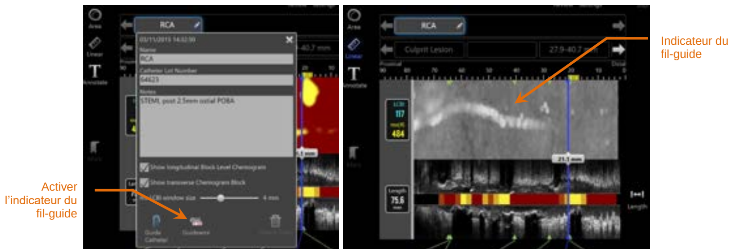
Figure 10-4 : la fenêtre d'édition du scan avec l'activation de l'indicateur de fil-guide activé (gauche) ; le chemogram est masqué et l'indicateur de fil-guide est visible (droite).
