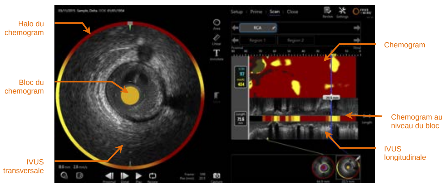
Figure 4-10 : phase « Scan » (Numérisation) du mode Acquisition avec les affichages principaux des informations sur l'image indiqués.
