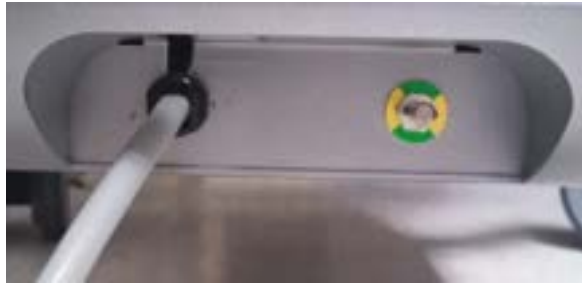
Figure 6-2 : goujon de mise à la terre équipotentiel situé à l'arrière du Makoto® Système d'imagerie intravasculaire à l'extrémité droite de la partie inférieure.
