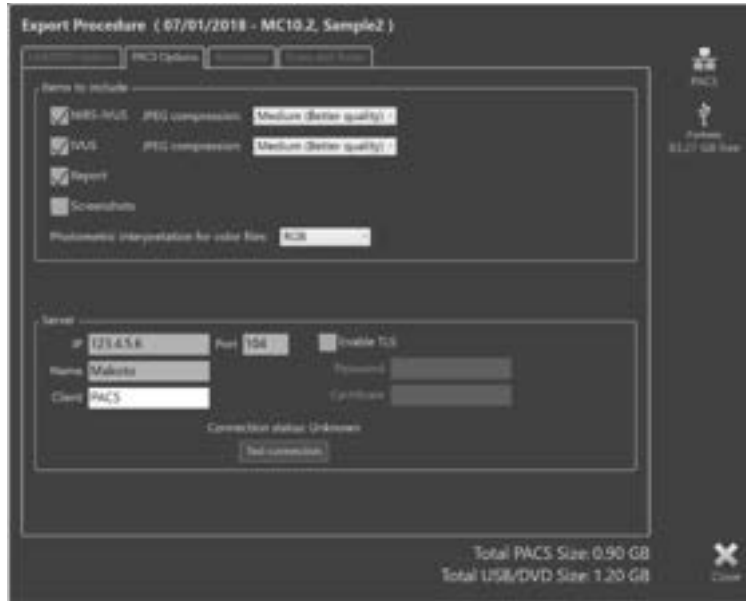
Figure 12-11 : fenêtre d'exportation personnalisée pour configurer des emplacements de stockage réseau alternatifs.
