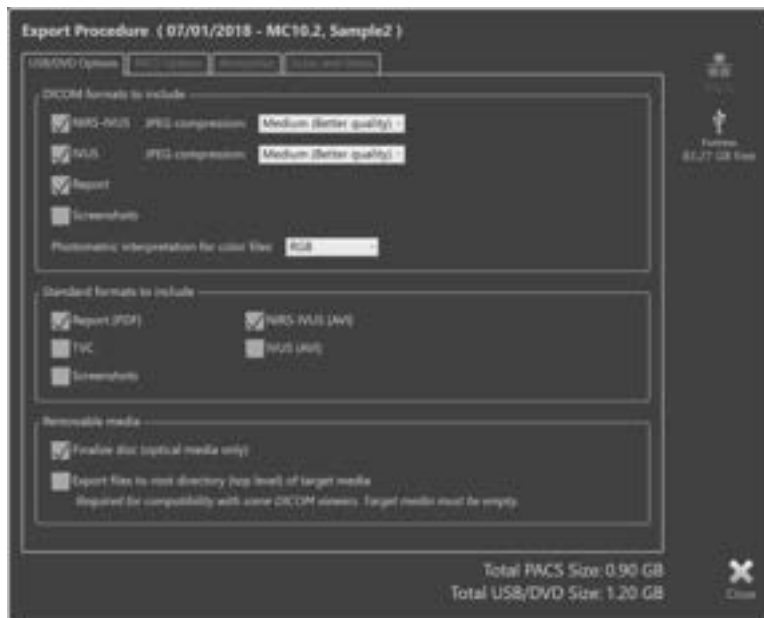
Figure 12-10 : fenêtre d'exportation personnalisée permettant de définir des types et des formats de données pour l'exportation vers des supports amovibles.
