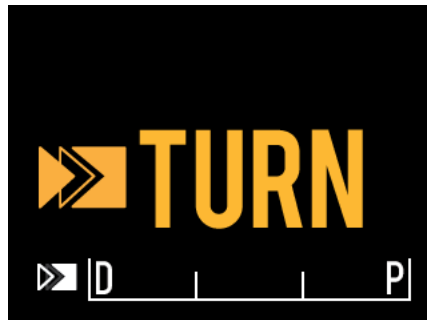
Figure 4-22 : l'écran LCD du contrôleur du Makoto® indiquant une instruction de tourner la poignée du cathéter.
