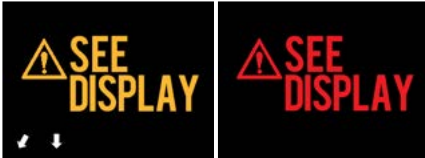
Figure 4-24 : Message d'erreur (gauche) et message de défaut interne (droite) du contrôleur Makoto®. Dans les deux cas, l'utilisateur est invité à consulter l'écran du système pour corriger l'erreur ou le défaut.
