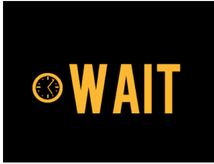
Figure 4-23 : l'écran LCD du contrôleur du Makoto® indiquant d'attendre que le système termine de démarrer par le statut « WAIT » (ATTENDRE).
