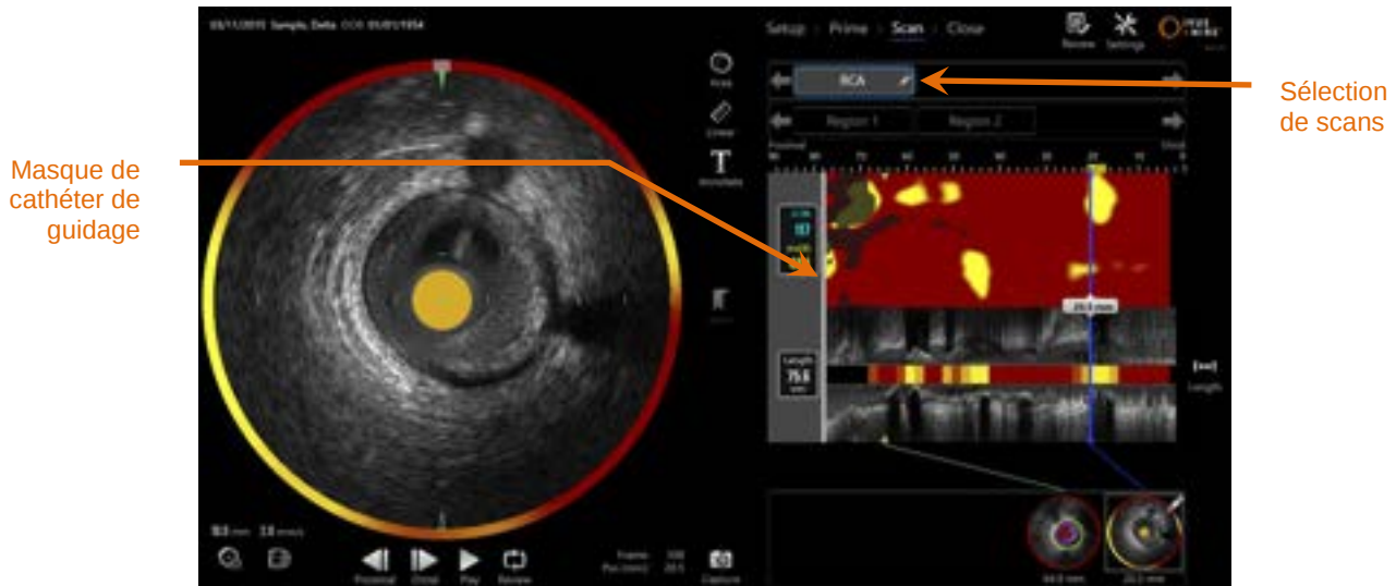
Figure 9-8 : Mode d'acquisition après l'achèvement d'un balayage IVUS+NIRS par retrait automatique avec un cathéter guide détecté.
