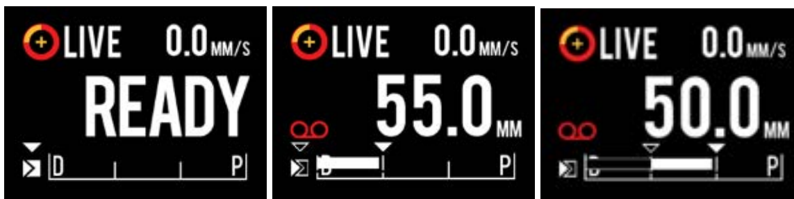
Figure 9-5 : Écran LCD du contrôleur Makoto® avec cathéter d'imagerie IVUS+NIRS connecté pendant le processus de transition du début du Live IVUS non enregistré sur READY (PRÊT) (gauche) à l'enregistrement, puis de la translation proximale et stationnaire du Live IVUS enregistré (milieu) à la remise à zéro, et à la translation proximale pendant l'enregistrement (droite). Remarquez l'apparition de l'icône d'enregistrement pendant le Live IVUS enregistré. Lorsque la translation est effectuée pendant le Live IVUS enregistré une barre pleine apparaît où l'enregistrement préalable à la dernière marque est une barre vide (droite).
