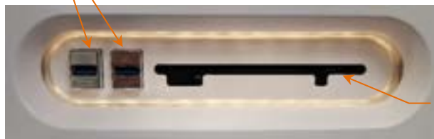
Figure 4-3 : panneau d'interface du côté gauche du Makoto® Système d'imagerie intravasculaire (TVC-MC10) intégrant les ports USB 3.0 et le lecteur de supports optiques Blu-Ray.
