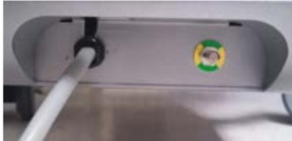
Figura 6-2. Il bullone di terra equipotenziale situato sul retro del sistema Makoto® Sistema di imaging intravascolare nell'angolo inferiore destro.
