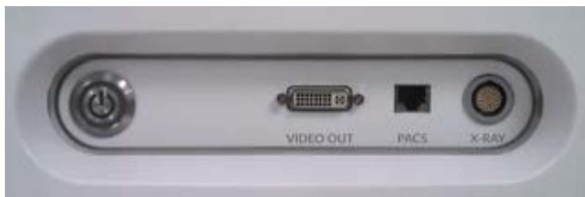
Figura 14-1. Video e pannello di esportazione di controllo del sistema Makoto® Sistema di imaging intravascolare
