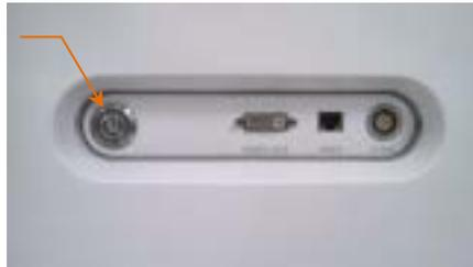
Figura 6-1. Pannello laterale del sistema Makoto® Sistema di imaging intravascolare con pulsante di accensione evidenziato.
