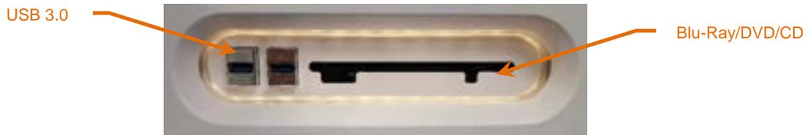
Figura 12-8. Pannello dei supporti rimovibili del sistema Makoto® Sistema di imaging intravascolare
