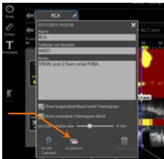
図 10-4 : ガイドワイヤ検出マップ切替有効時の編集ウィンドウ（左）；Chemogram が隠され ガイドワイヤ検出マップが表示されます（右）
