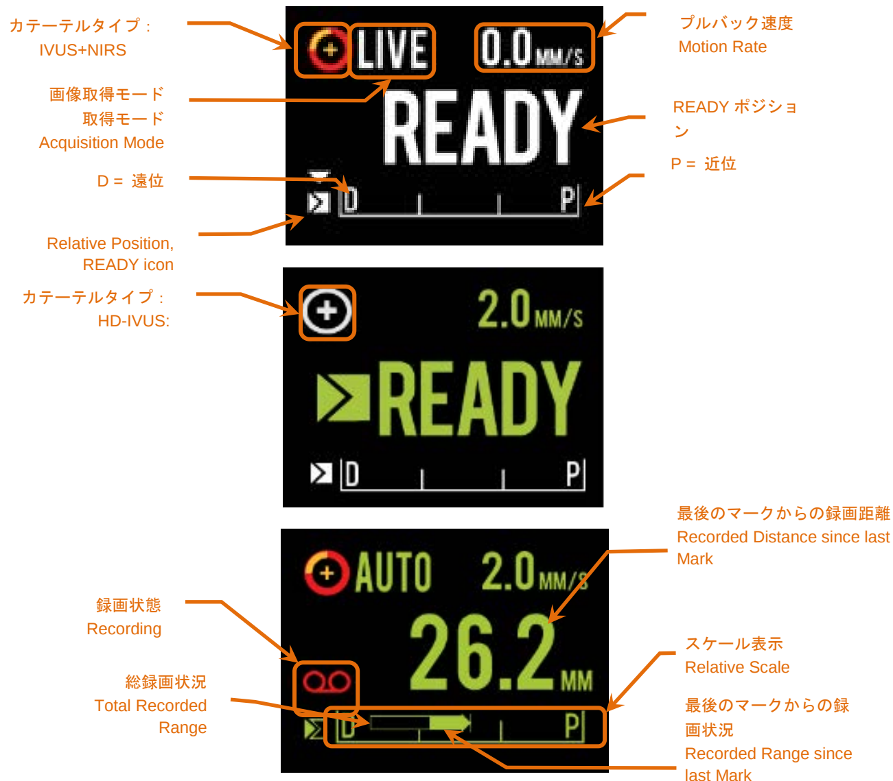
図 4-17 : Makoto™ Controller の LCD スクリーンにおける表示は、Live IVUS 取得中に IVUS+NIRS 対応カテーテルが接続され READY 状態の場合（上）、HD-IVUS 専用カテーテルが接続され READY 状態でアイドル状態の場合（中）、および IVUS+NIRS 対応カテーテルによる自動プルバック取得中の場合（下）を示します。
