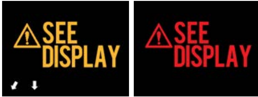
図 4-24 Makoto™ コントローラのエラーメッセージ（左）と内部障害（右）メッセージ。どちらの場合も、ユーザはシステムモニタでエラーまたは障害と次のアクションについての指示を調べる必要があります。
