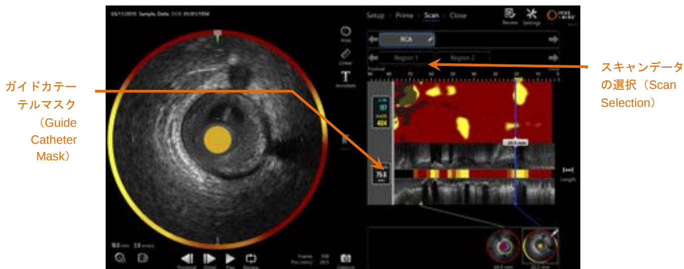
図 9-8 : ガイドカテテルが検出された IVUS+NIRS オートプルバック後の取得 (Acquisition) モード
