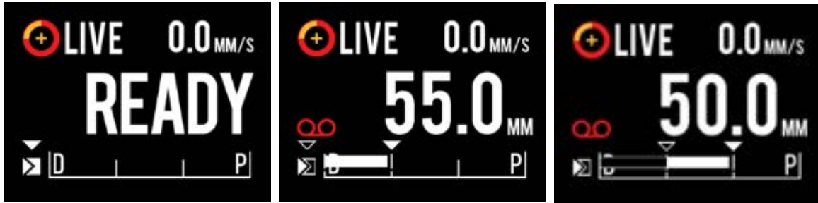
図 9-5 : READY になっている録画していないライブ IVUS の開始位置（左）から録画へ、次に近位と静止しているライブ IVUS の翻訳（中央）、そこから録画中に近位をゼロ化して翻訳する（右） 転換プロセス中の Dualpro™ IVUS+NIRS イメージングカテーテルを搭載した Makoto™ コントローラ LCD スクリーン。録画されているライブ IVUS 中は録画アイコンが表示されています。録画されているライブ IVUS 中に翻訳が実行されると、この取得で最後のマーク以来録画が既に実行されているところに塗りつぶされたバーが表示され（中央と右）、一番最近のマークより前の録画は枠だけのバーが表示されます（右）。
