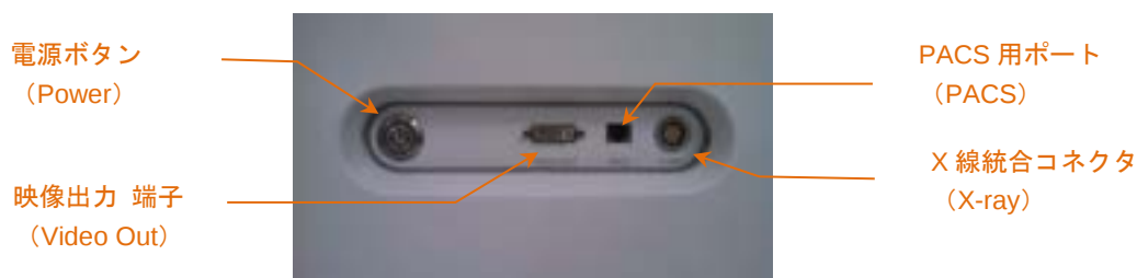
図 4-4 : 電源ボタン、映像出力端子、PACS 用ポート、および X 線統合コネクタを含む Makoto™ 血管内イメージングシステム (TVC-MC10) の右側インターフェースパネル
