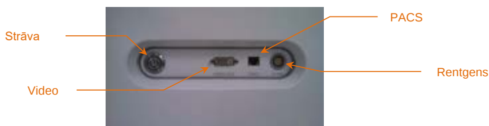
Attēls 4-4: Makoto® Intravascular Imaging System (TVC-MC10) labās puses interfeisa panelis, kurā atrodas ieslēgšanas poga, video izeja, PACS un rentgena integrēšanas savienotāji.
