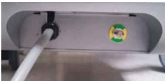
Figure 6-2; Ekvipotenciālais sazemēšanas uzgalis, kas atrodas Makoto® Intravascular Imaging System aizmugures apakšējā labajā pusē.
