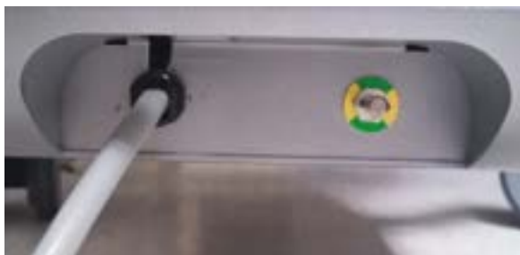
Afbeelding 6-2: potentiaalvereffeningsstift aan de achterkant van het Makoto® Intravasculair beeldvormingssysteem, rechtsonder.
