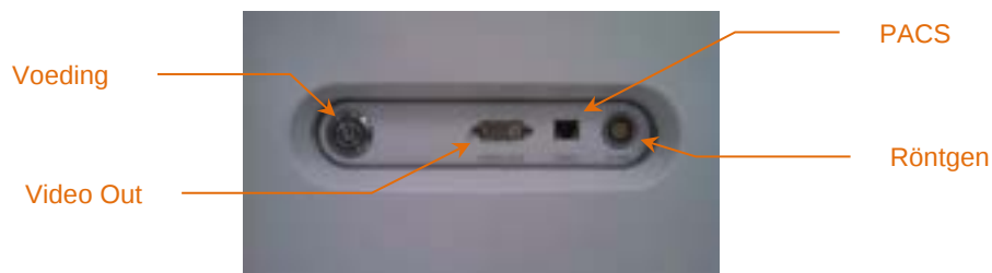
Afbeelding 4-4: Rechter interfacepaneel van het Makoto® Intravasculair beeldvormingssysteem (TVC-MC10) met de aan/uit-knop, video-uitgang, PACS- en röntgenaansluitingen.
