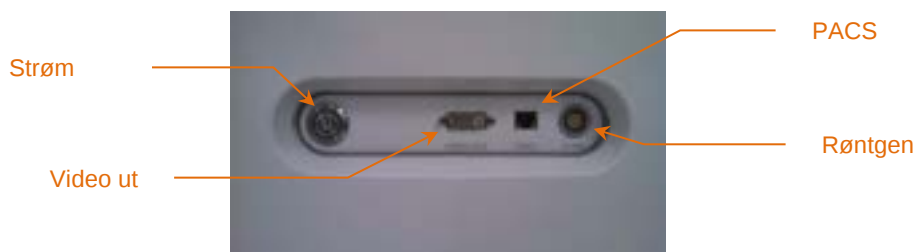
Figur 4-4: Høyre side-grensesnittpanel i Makoto® Intravaskulært bildesystem (TVC-MC10) som inneholder strømknappene, videoutgangene, PACS og røntgenintegrasjonskontakter.
