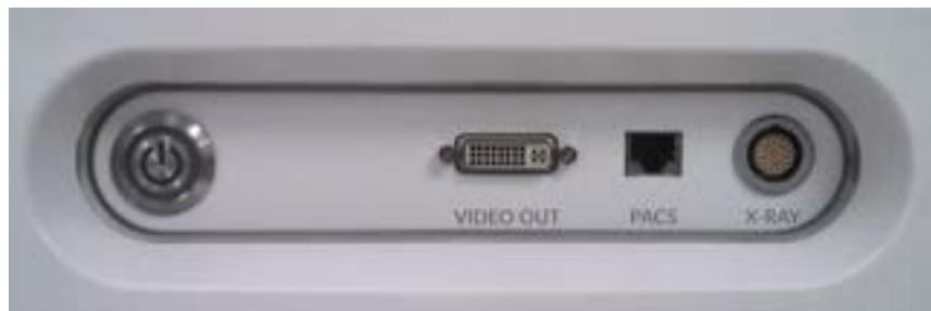
Figur 14-1: Makoto® Intravaskulært bildesystem video- og kontrolleksportpanel
