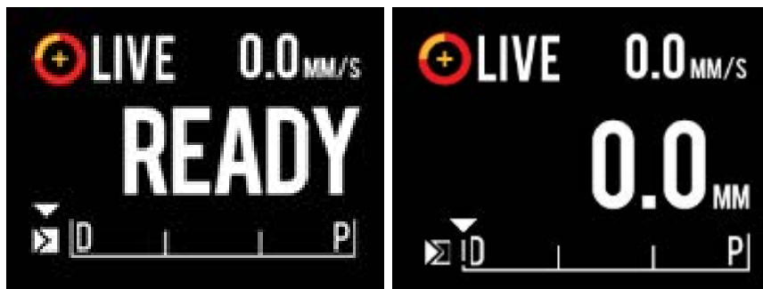
Figur 9-2: Makoto®-kontrolleren som viser live IVUS-avbildninger som ikke er registrert i KLAR-posisjonen (venstre) og 0,0 mm-posisjonen (høyre).
