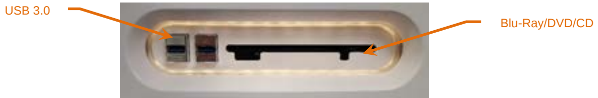
Figur 12-8: Makoto® Intravaskulært bildesystem fjernbart mediepanel
