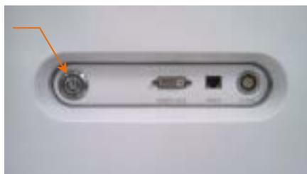
Figura 6-1: Painel lateral do Sistema de Captação de Imagens Intravascular Makoto® com o botão de alimentação em destaque
