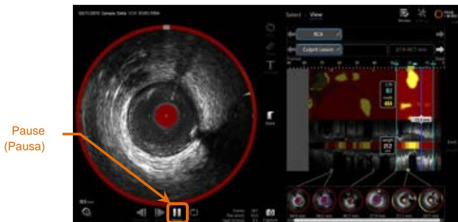
10-7: Fase de Varredura do Modo de Aquisição durante a reprodução automática com o controle de Pausa em evidência.
