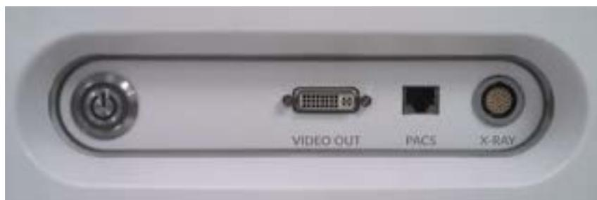
Figura 14-1: Painel de Vídeo e controle de exportação do Sistema de Captação de Imagens Intravascular Makoto®
