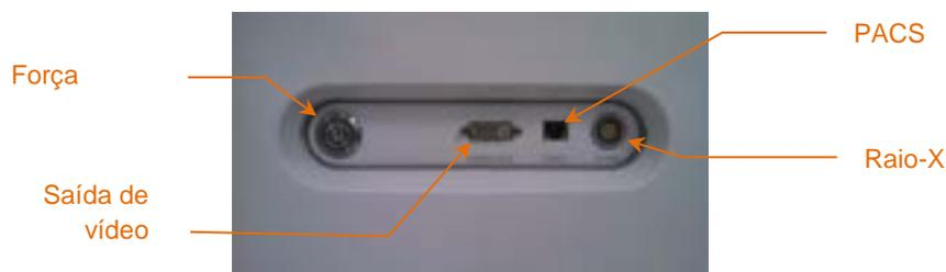
Figura 4-4: Painel de interface do lado direito do Sistema de Captação de Imagens Intravascular Makoto® (TVC-MC10) contendo o botão liga/desliga, saída de vídeo, PACS e conectores de integração de raios-X.
