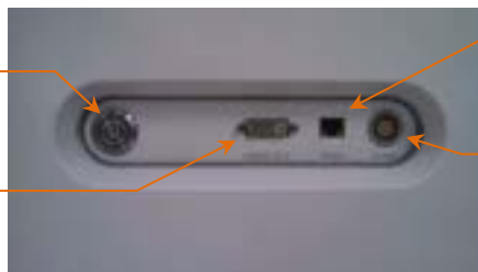
Obrázok 4-4: Panel rozhrania na pravej strane intravaskulárneho zobrazovacieho systému Makoto® (TVC-MC10) s tlačidlom Napájanie, video výstupom, PACS a konektorom na pripojenie röntgenu.
