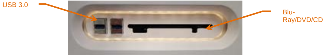
Figur 12-8: Makoto® intravaskulära avbildningssystemets panel för flyttbara medier
