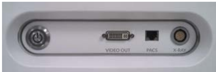
Figur 14-1: Makoto® intravaskulära avbildningssystemets panel för export av videosignaler och delad kontroll.
