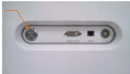
Figur 6-1: Makoto® intravaskulära avbildningssystemets sidopanel med strömbrytaren markerad.
