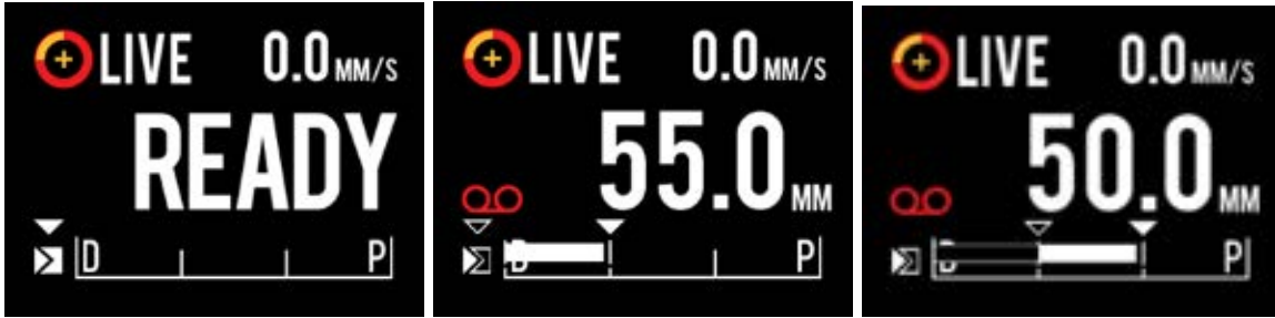
Hình 9-5. Màn hình LCD Makoto® Controller có Ống Thông Chụp Chiếu IVUS+NIRS được kết nối trong quá trình chuyển từ khi bắt đầu Live IVUS chưa được ghi lại ở vị trí READY (SẴN SẴNG) (bên trái) sang ghi lại, sau đó dịch chuyển gần và tĩnh Live IVUS (giữa) về không và dịch chuyển gần trong khi ghi lại (bên phải). Lưu ý sự xuất hiện của biểu tượng ghi lại trong quá Live IVUS được ghi lại. Khi thực hiện quá trình dịch chuyển trong quá trình Live IVUS được ghi lại, một thanh liên sẽ xuất hiện ở vị trí của bản ghi trong lần thu đã được thực hiện kể từ lần Mark (Đánh Dấu) cuối cùng (giữa và bên phải) và bản ghi trước lần Mark (Đánh Dấu) gần nhất là một thanh trống (bên phải).
