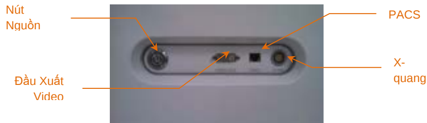
Hình 4-4: Bảng giao diện bên phải của Hệ Thống Chụp Chiếu Nội Mạch Makoto® (TVC-MC10) chứa Nút Nguồn, Đầu Xuất Video, PACS và các đầu nối Tích Hợp X-quang.
