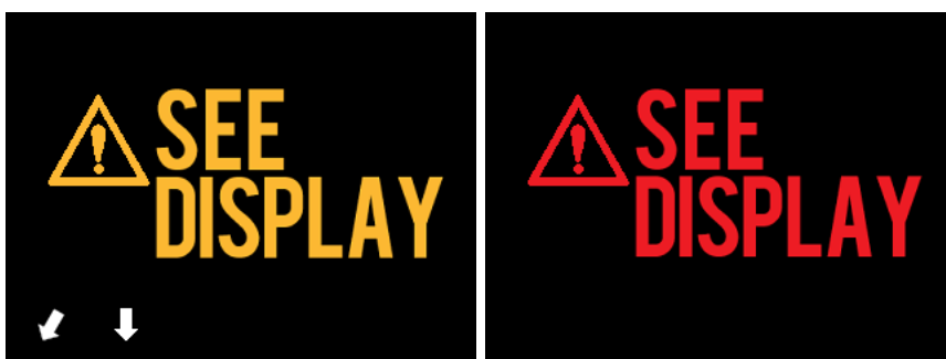
Obrázek 4-24 Chybová zpráva ovladače Makoto® (vlevo) a chybová zpráva interní chyby (vpravo). V obou případech by uživatel měl postupovat podle pokynů uvedených na monitoru systému, jak konkrétní chybu napravit.
