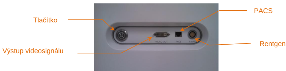
Obrázek 4-4: Pravá strana panelu s rozhraním zobrazovacího intravaskulární zobrazovací systém Makoto® (TVC-MC10) obsahující tlačítko napájení, výstup videosignálu a konektory pro integraci systému PACS a rentgenového zařízení.
