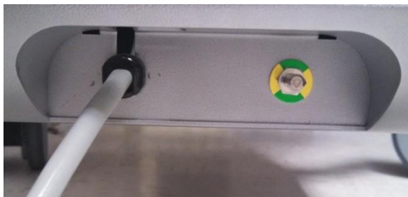
Obrázek 6-2: Uzemňovací kolík pro vyrovnání elektrických potenciálů umístěný na zadní straně zobrazovacího intravaskulární zobrazovací systém Makoto® u pravého dolního okraje.
