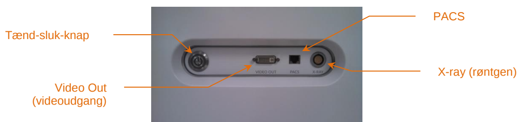
Figur 4-4: Højre grænsefladepanel på Makoto® Intravaskulært billeddannelsessystem (TVC-MC10), der indeholder Power Button (tænd/sluk-knap) og stikkene Video Out (videoudgang), PACS og X-ray (røntgen).
