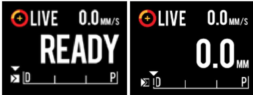
Abbildung 9-2: Anzeige einer Live-IVUS-Erfassung auf dem Makoto® Controller, die an der Position BEREIT (links) und der Position 0,0 mm (rechts) nicht aufgezeichnet wird.
