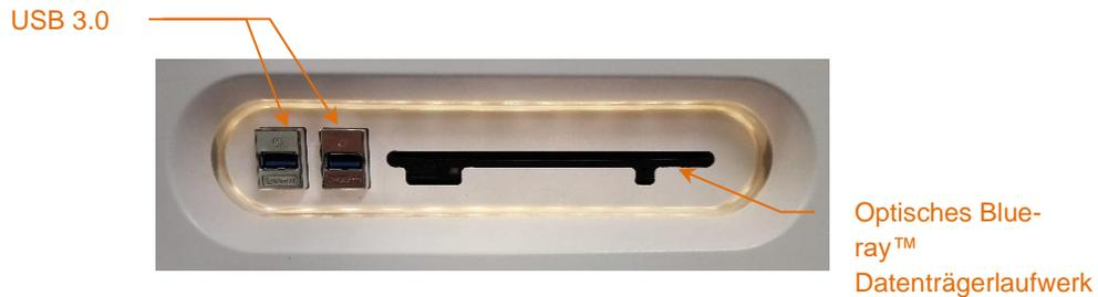
Abbildung 4-3: Linksseitiges Schnittstellen-Panel des Makoto® Intravaskulären Bildgebungssystems (TVC-MC10), das USB 3.0-Anschlüsse und ein optisches Blue-ray™ Datenträgerlaufwerk enthält.
