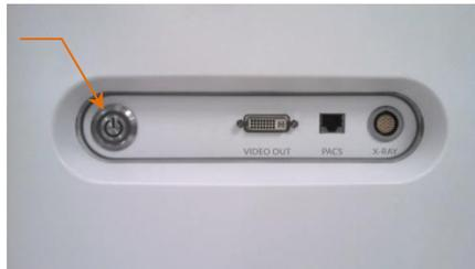
Abbildung 6-1: Makoto® Intravaskuläres Bildgebungssystem Seitenpanel mit hinterleuchteter Ein-/Austaste.
