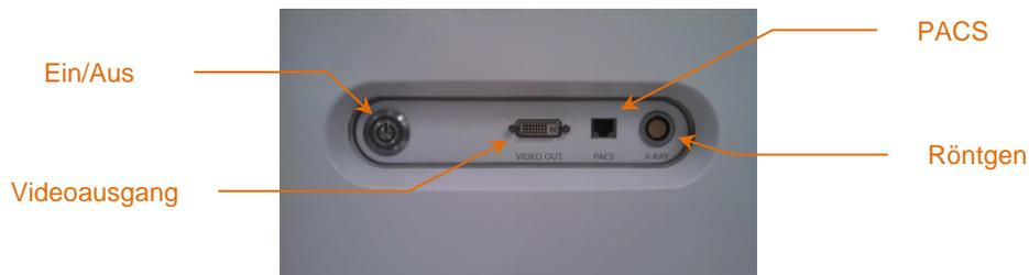
Abbildung 4-4: Rechtsseitiges Schnittstellen-Panel des Makoto® Intravaskulären Bildgebungssystems (TVC-MC10), mit Ein-/Ausschalter, Videoausgang, PACS und Röntgen-Integrationsanschlüssen.
