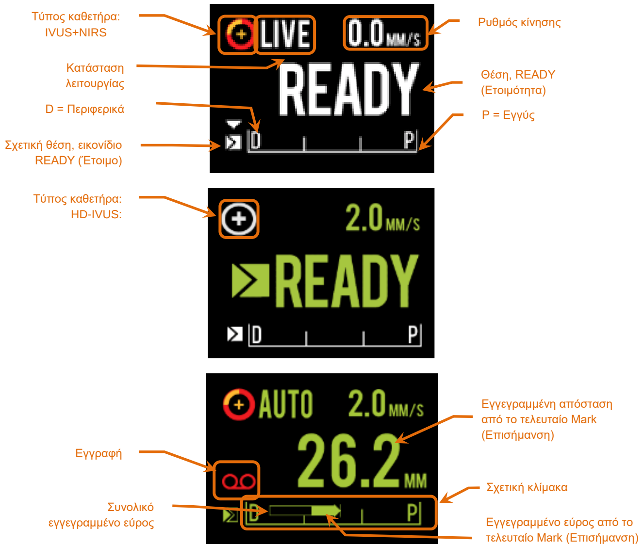
Εικόνα 4-17: Ενδείξεις οθόνης LCD του Makoto® Controller σε λήψη Live IVUS σε θέση READY (Ετοιμότητα) με συνδεδεμένο καθετήρα με δυνατότητα IVUS+NIRS (άνω), αδρανής με συνδεδεμένο καθετήρα με δυνατότητα HD-IVUS μόνο σε θέση READY (Ετοιμότητα) (μέση) και κατά τη διάρκεια λήψης αυτοματοποιημένης απόσυρσης με καθετήρα με δυνατότητα IVUS+NIRS (κάτω).
