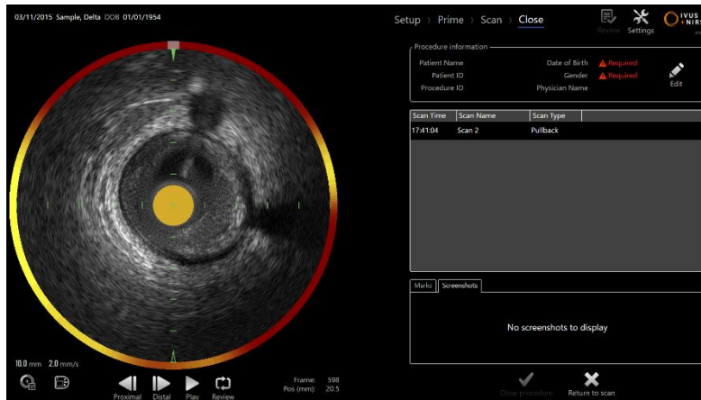
4-12: Φάση Close (Κλείσιμο) της κατάστασης λειτουργίας λήψης.
