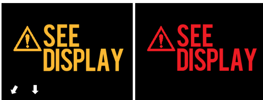
Εικόνα 4-24 Το μήνυμα σφάλματος του Makoto® controller (αριστερά) και εσωτερικά μηνύματα προβλημάτων (δεξιά). Και στις δύο περιπτώσεις, ο χρήστης θα πρέπει να συμβουλευτεί την οθόνη του συστήματος για οδηγία σχετικά με το λάθος ή το πρόβλημα και τις επόμενες ενέργειες.
