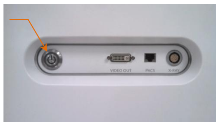
Εικόνα 6-1: Πλευρικός πίνακας του συστήματος ενδαγγειακής απεικόνισης Makoto® με επισημασμένο τον διακόπτη ρεύματος.
