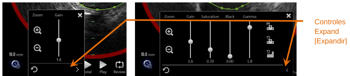
Figura 10-25: Configuraciones de imagen transversal. Controles básicos, izquierda. Controles avanzados, derecha.
