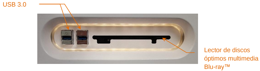
Figura 4-3: Panel de interfaz izquierdo del Sistema de Imágenes Intravascular Makoto® (TVC-MC10) que contiene conectores USB 3.0 y un lector de discos óptimos multimedia Blu-ray™.
