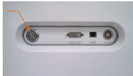
Figura 6-1: Panel lateral del Sistema de Imágenes Intravascular Makoto® con el botón de encendido marcado.
