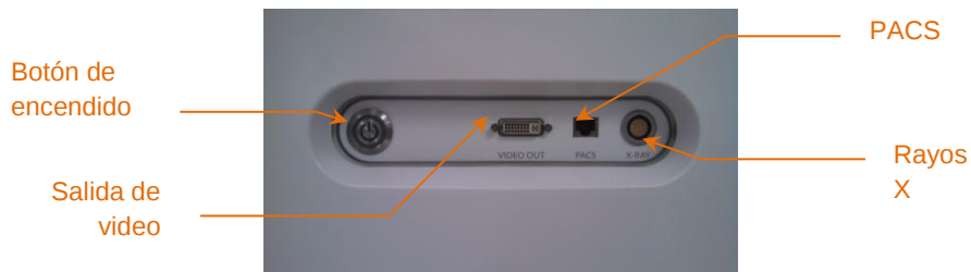
Figura 4-4: Panel de interfaz del lado derecho del Sistema de Imágenes Intravascular Makoto® (TVC-MC10) que contiene el botón de encendido, la salida de video, PACS y conectores de integración de rayos X.
