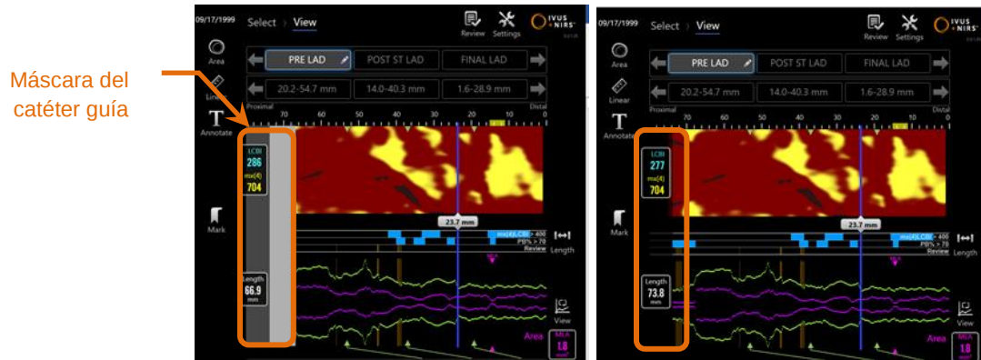
Figura 10-3: Edición de Escaneo con máscara de catéter guía activada (izquierda). Edición de Escaneo con máscara de catéter guía desactivada (derecha) (Funciones opcionales de SmartImaging™ activadas).
