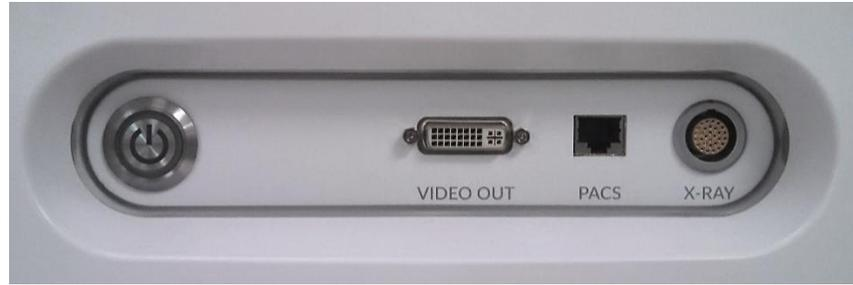
Figure 15-1 : panneau d'exportation vidéo et de contrôle du Makoto® Système d'imagerie intravasculaire
