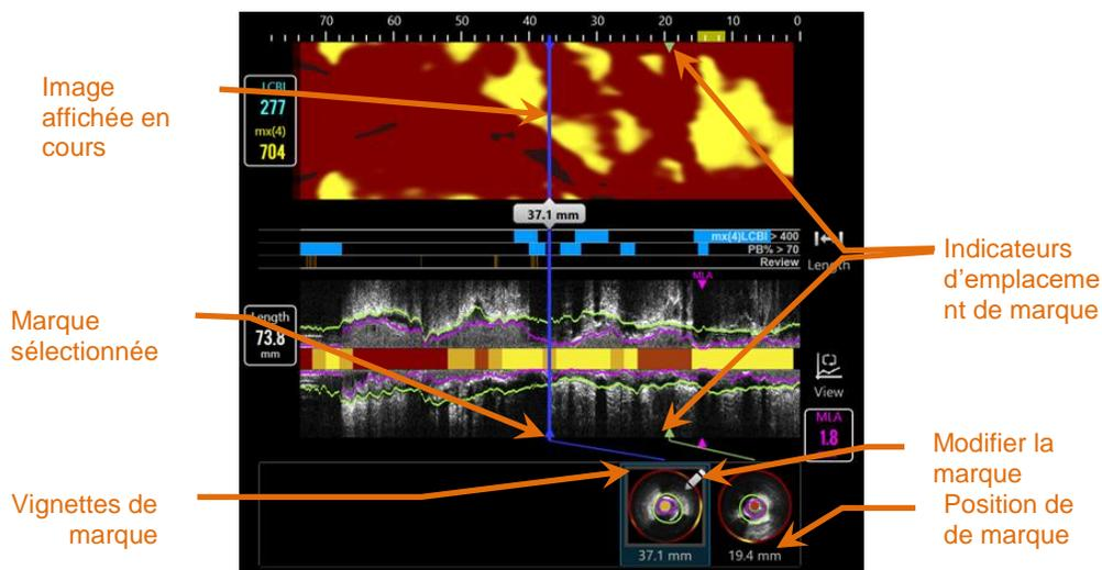
Figure 10-8 : Les positions des marques sont affichées par des indicateurs en forme de triangle vert sur le Chemogram et l'IVUS longitudinal, accompagnées d'une vignette visuelle montrant le contenu de l'image mise en surbrillance. (fonctions optionnelles SmartImaging™ activées).
