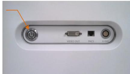
Figure 6-1 : panneau latéral et bouton d'alimentation Makoto® Système d'imagerie intravasculaire sélectionnés.
