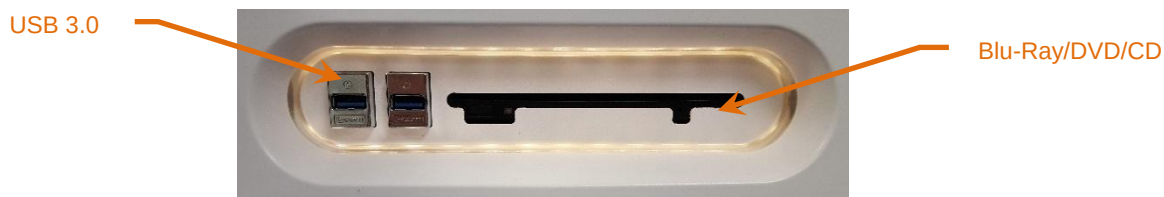
Figura 12-7. Pannello dei supporti rimovibili del sistema Makoto® Sistema di imaging intravascolare
