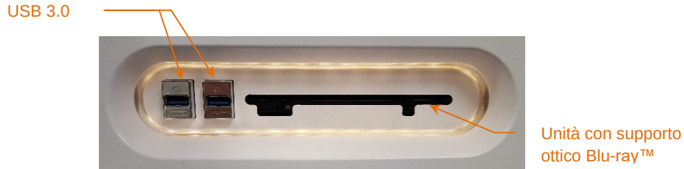
Figura 4-3. Pannello sinistro dell'interfaccia del sistema Makoto® Sistema di imaging intravascolare (TVC-MC10) contenente connettori USB 3.0 e unità di supporto ottico Blu-ray™.
