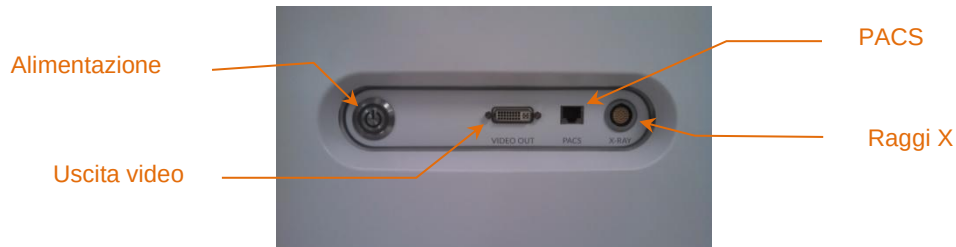
Figura 4-4. Pannello destro dell'interfaccia del sistema Makoto® Sistema di imaging intravascolare (TVC-MC10) contenente il pulsante di alimentazione, uscita video, PACS e connettori di integrazione raggi X.
