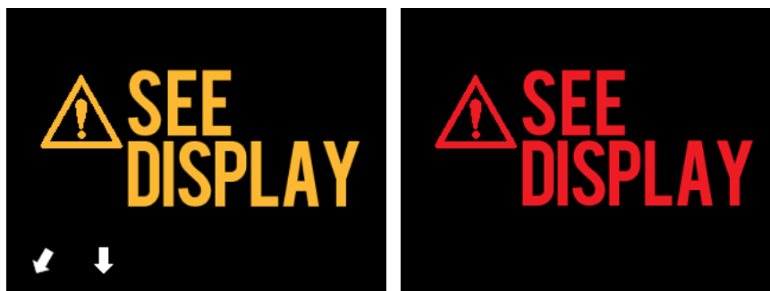
図 4-24 Makoto® Controller のエラーメッセージ(左)と内部障害(右)メッセージ。どちらの場合も、ユーザはシステムモニタでエラーまたは障害と次のアクションについての指示を調べる必要があります。
