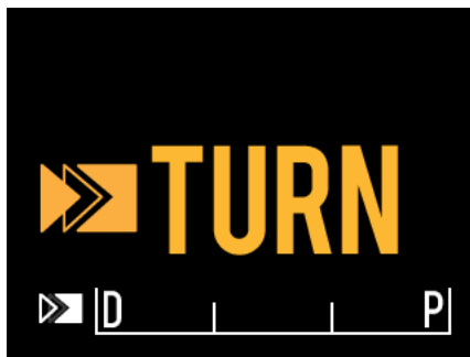
図 4-22: Makoto® Controller の LCD スクリーンに表示されるカテーテルハンドルを回す指示。
