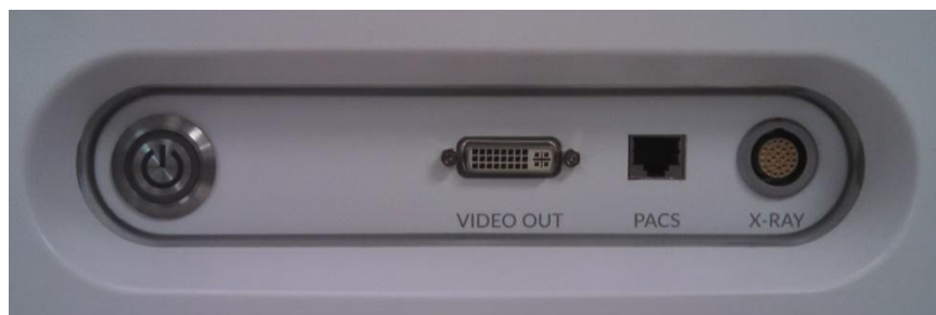
図 15-1: 映像出力端子 (VIDEO OUT)、PACS 用ポート、および X 線統合コネクタ (X-RAY) を含むインターフェースパネル
