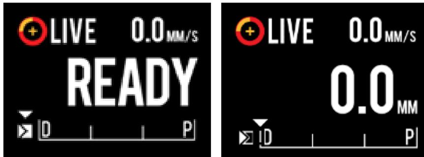
그림 9-2. 준비 위치(좌측) 및 0.0 mm 위치(우측)에 기록되지 않는 실시간 IVUS 획득을 보여주는 Makoto® 컨트롤러.
