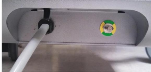
그림 6-2: 우측 하단 모서리에 Makoto® 혈관 내 영상 시스템의 뒷면에 위치한 등전위의 접지 스타드.
