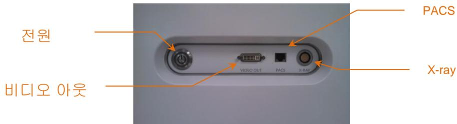
그림 4-4: 전원 버튼, 비디오 아웃, PACS, 및 X-ray 통합 커넥터를 포함한 Makoto® 혈관 내 영상 시스템 (TVC-MC10)의 우측 인터페이스 패널.
