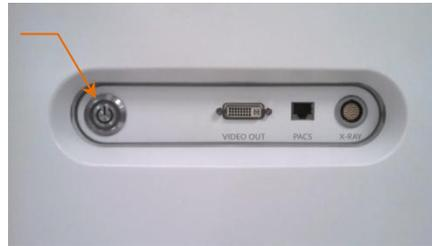
그림 6-1: 전원 버튼이 강조 표시된 Makoto® 혈관 내 영상 시스템 측면 패널
