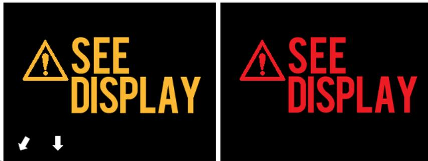
그림 4-24 Makoto® 컨트롤러의 에러 메시지(왼쪽)와 내부 오류(오른쪽) 메시지. 두 경우 모두 사용자가 시스템 모니터에서 오류 또는 결합 및 다음 조치에 대한 지침을 참조해야 합니다.
