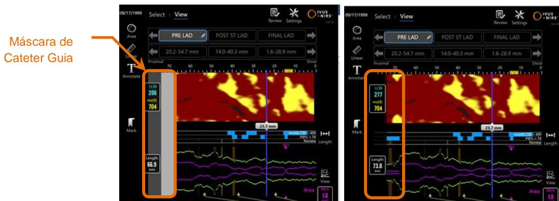
Figura 10-3: Edição da Varredura com a ativação da máscara do Cateter Guia (esquerda). Edição da Varredura com a desativação da máscara do Cateter Guia (direita) (recursos opcionais SmartImaging™ habilitados).
