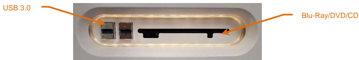
Obrázok 12-7: Panel vymeniteľných médií intravaskulárneho zobrazovacieho systému Makoto®.
