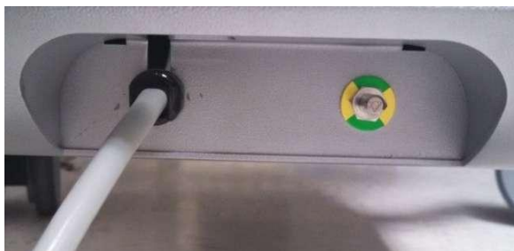
Obrázok 6-2; Kolík ekvipotenciálneho uzemnenia umiestnený na pravom dolnom okraji na zadnej strane intravaskulárneho zobrazovacieho systému Makoto®.
