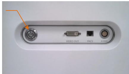
Figur 6-1: Makoto® intravaskulära avbildningssystemets sidopanel med strömbrytaren markerad.
