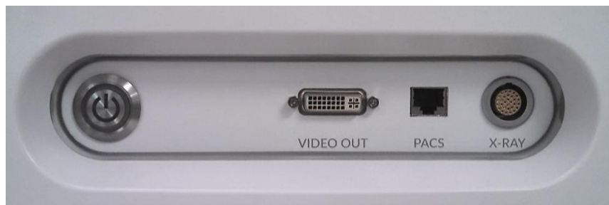
Figur 15-1: Makoto® intravaskulära avbildningssystemets panel för export av videosignaler och delad kontroll.
