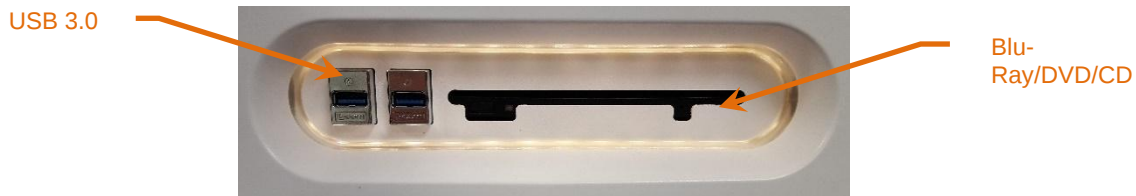
Figur 12-7: Makoto® intravaskulära avbildningssystemets panel för flyttbara medier
