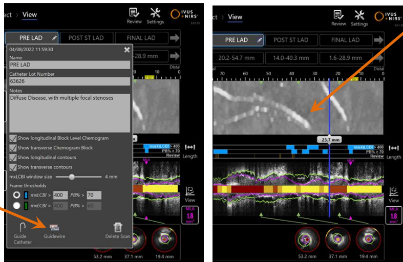
Hình 10-4: Cửa sổ Chỉnh Sửa Bản Quét với nút chuyển đổi Bản Đồ Dây Dẫn được bật (bên trái); Chemogram ở chế độ âm và Bản Đồ Dây Dẫn hiển thị (bên phải) (các tính năng tùy chọn SmartImaging™ được bật).
