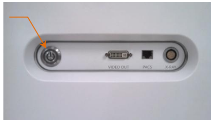
Hình 6-1: Bảng bên của Hệ Thống Chụp Chiếu Nội Mạch Makoto® với nút nguồn được tô sáng.
